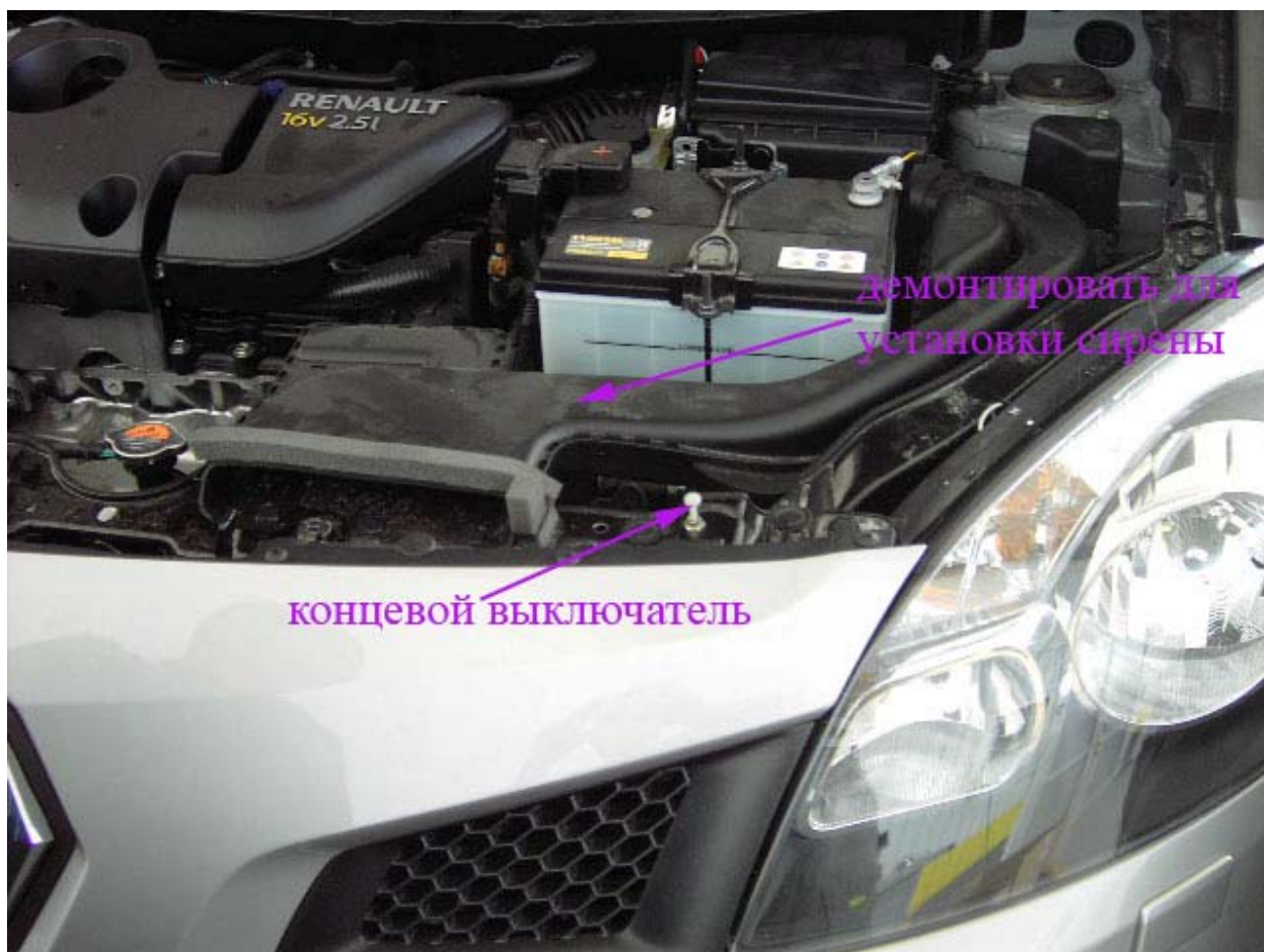
Рис.8 Размещение оборудования в моторном отсеке.
