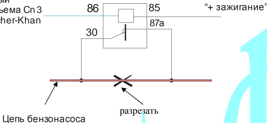
Схема 1: Подключение цепи блокировки.
