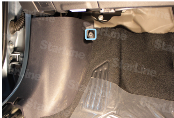
Фото 1.1. Поворотная клипса левой кик-панели
