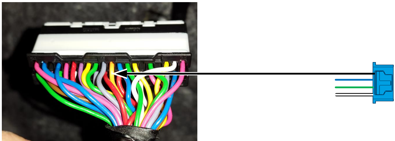
Рис. 14. Подключение контроля нажатия кнопки отпирания багажника по входу K-Line на Nissan Tiida C13 с кнопкой Start Stop.
