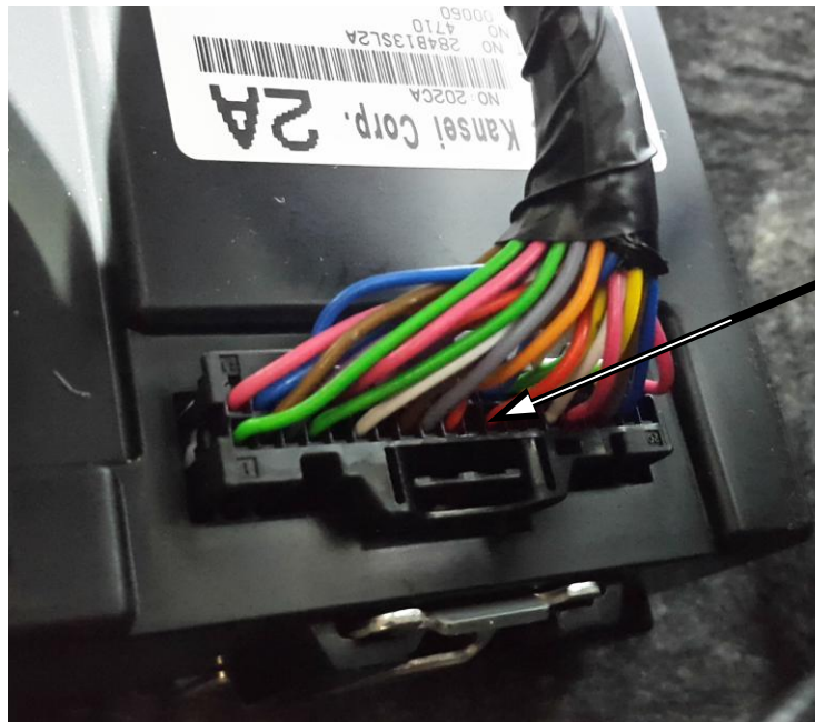
Рис. 11. Подключение имитации нажатия педали тормоза.
