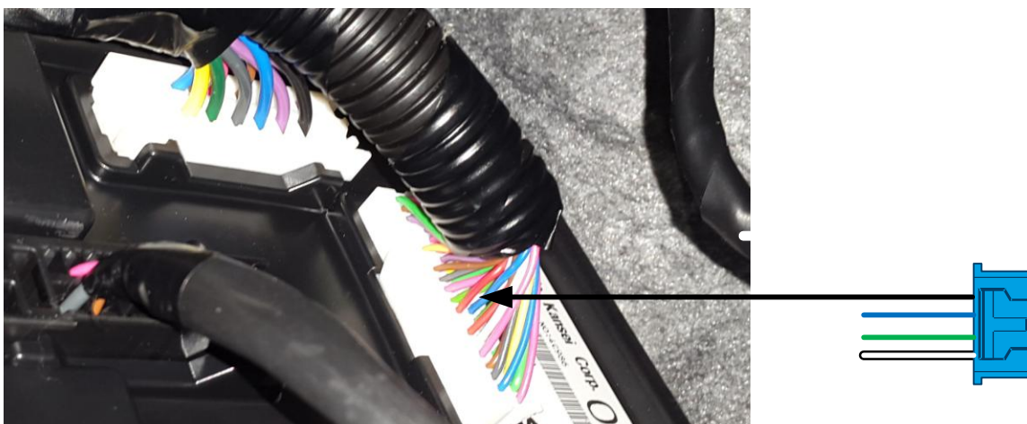
Рис. 13. Подключение контроля нажатия кнопки отпирания багажника по входу K-Line на Nissan Tiida C13 с механическим ключом зажигания.
