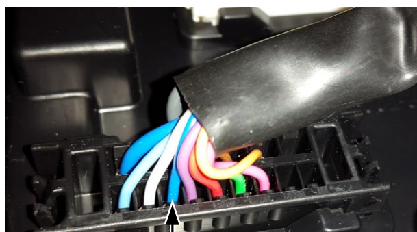
Рис. 9. Подключение датчика двери водителя.
