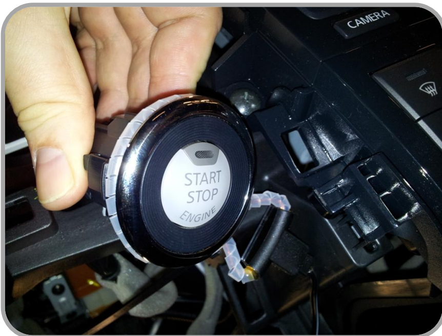
Рисунок 7. Расположение внешней антенны модуля обхода иммобилайзера
