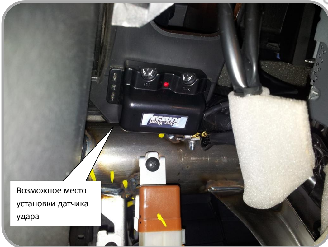
Рисунок 11. Установка датчика удара
