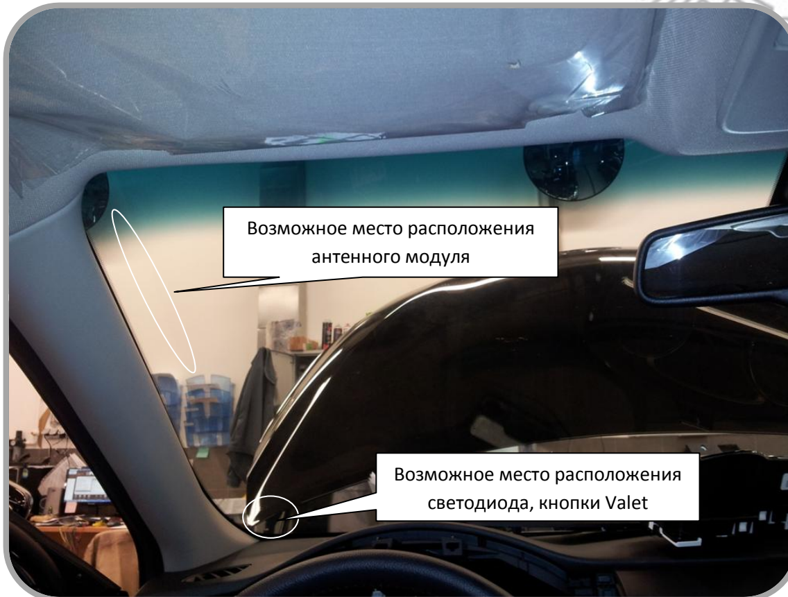
Рисунок 14. Установка светодиода, кнопки Valet и антенного модуля
