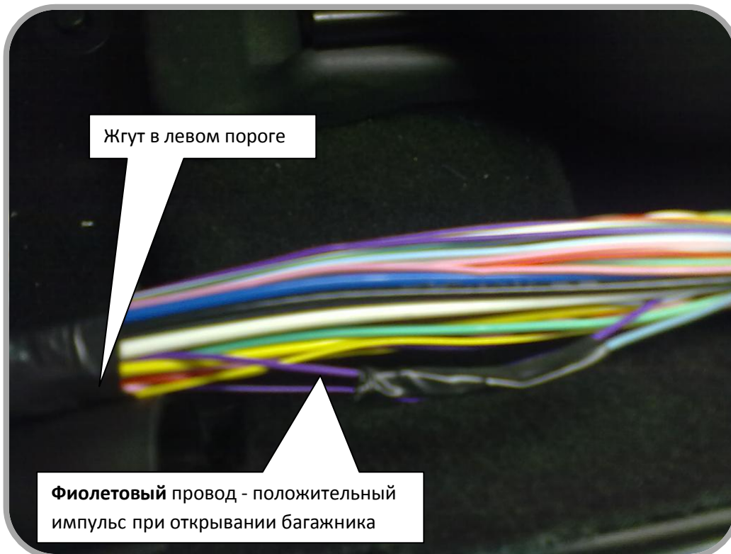
Рисунок 9. Реализация Slave по отпиранию багажника
