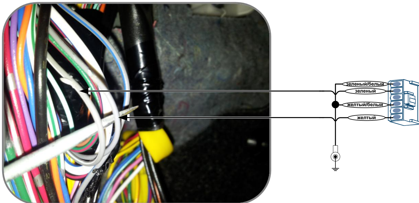
Рис.2 подключение центрального замка
