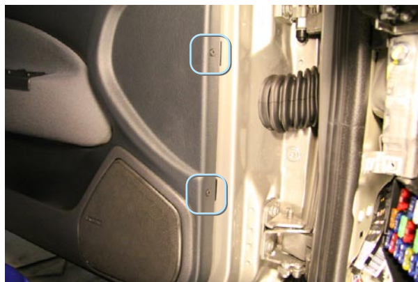
Фото 2.1. Саморезы крепления обшивки двери
