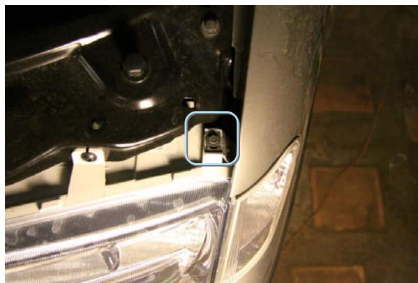
Фото 6.1. Винт крепления указателя поворотов
