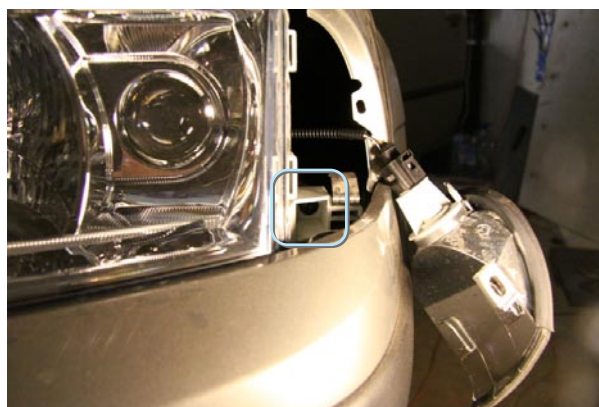
Фото 6.3. Саморез крепления блок-фары
