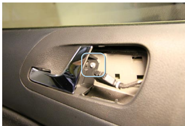
Фото 2.6. Саморез под регулировкой зеркал
