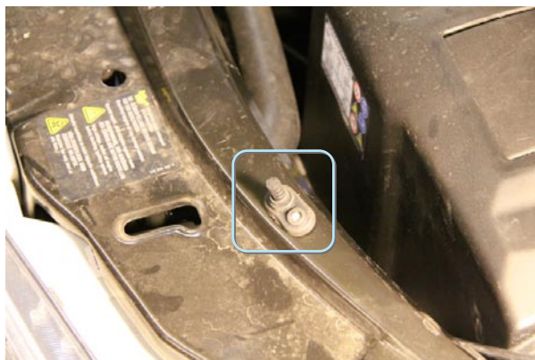
Фото 6.7. Концевик капота (отрезать 2 деления)
