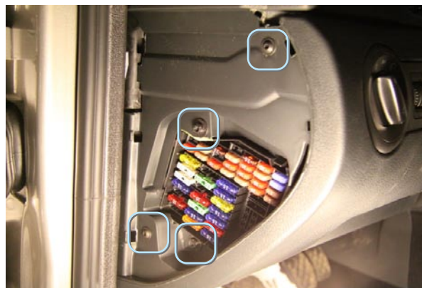
Фото 1.2. Крепление подторпедника и блока предохранителей
