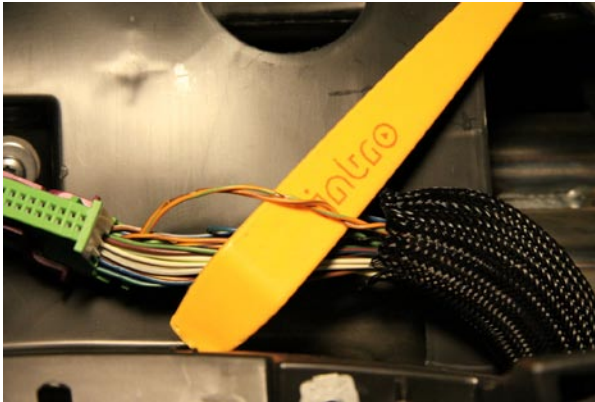
Фото 9.3. CAN-шина в жгуте приборного щитка
