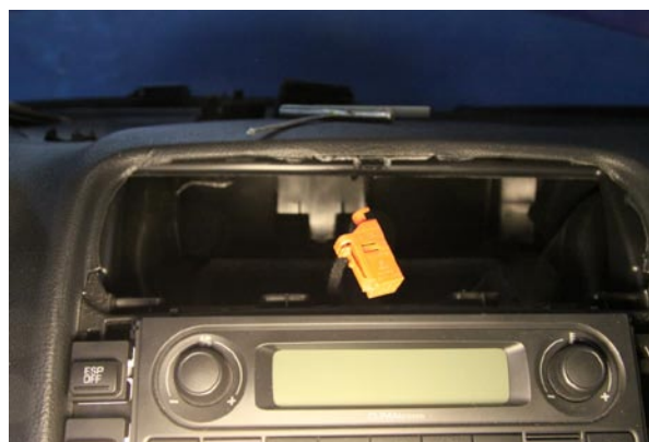
Фото 3.2. Снятие центрального дефлектора
