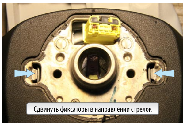
Фото 2.1. Снятие подушки безопасности
