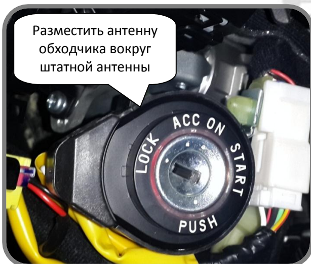
Рис. 4: Место установки антенны иммобилайзера
