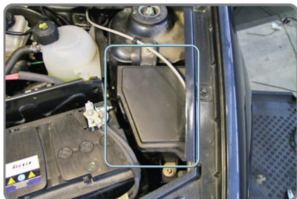
Фото 18.1. Блок реле и предохранителей
