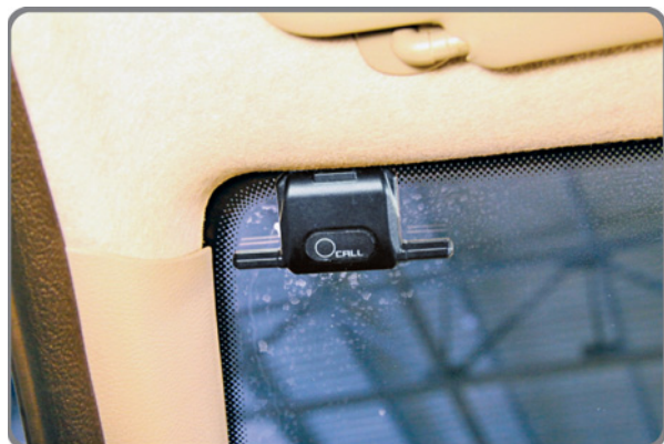
Фото 5.3. Антенный модуль на лобовом стекле
