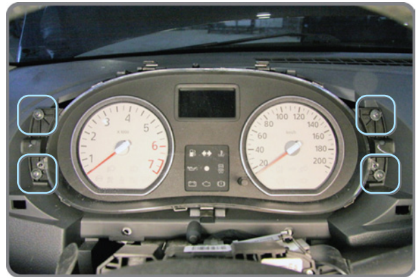
Фото 2.2. Крепление приборного щитка
