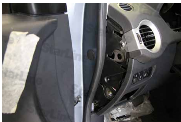
Фото 1.1 Снятие накладки на торпеде
