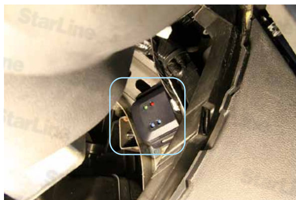
Фото 5.4 Датчик удара (место крепления обезжирить!)
