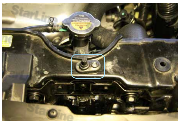
Фото 4.4 Концевик (отрезать 3 деления)
