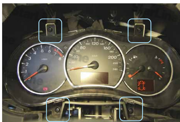
Фото 3.4 Крепление приборного щитка
