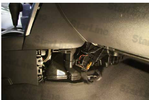
Фото 2.5 Снятие боковой нижней правой накладки
