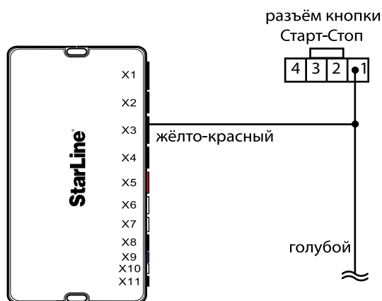
Схема 1. Подключение дополнительного канала №2 к кнопке Старт-Стоп
