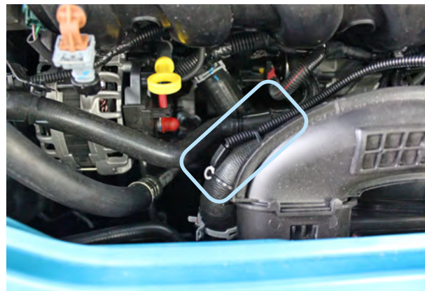
Фото 5.4. Крепление датчика температуры двигателя
