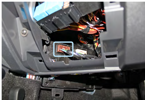
Фото 9.3. Местоположение коричневого разъёма блока ЦКБС
