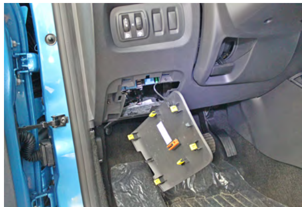
Фото 1.2. Пластиковая накладка снята
