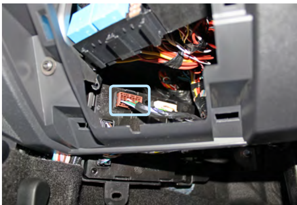
Фото 13.1. Местоположение коричневого разъёма блока ЦКБС
