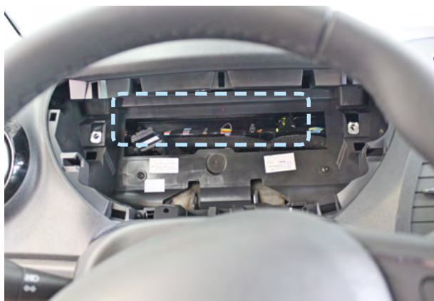
Фото 6. Пример расположения центрального блока охранно-телематического комплекса
