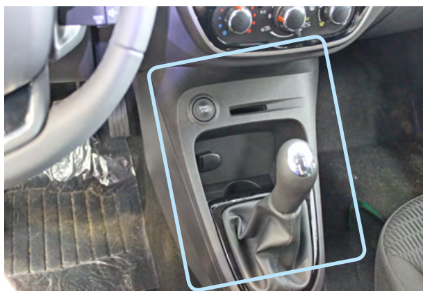
Фото 3.1. Пластиковая накладка под блоком управления климатической системой
