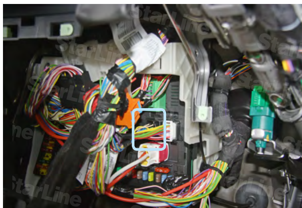
Фото 8.1. Местоположение разъёма на блоке BCM
