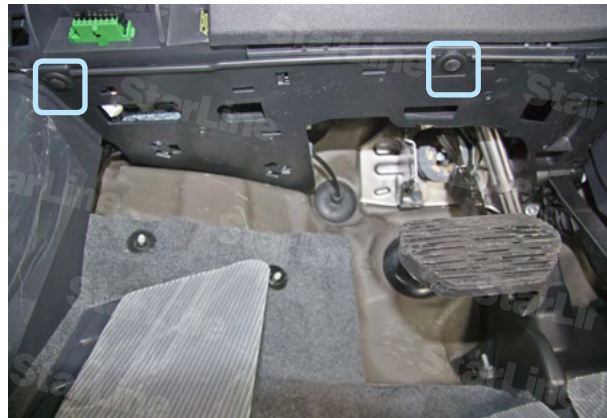
Фото 1.2. Клипсы крепления защитной накладки педального узла
