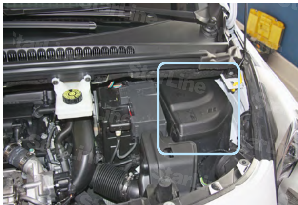
Фото 4.7. Возможное место установки подкапотного блока R6
