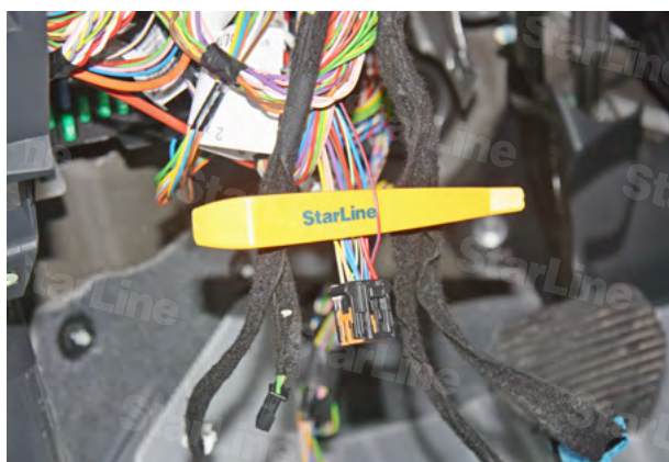
Фото 8.3. Альтернативное управление световыми сигналами (красно-синий)
