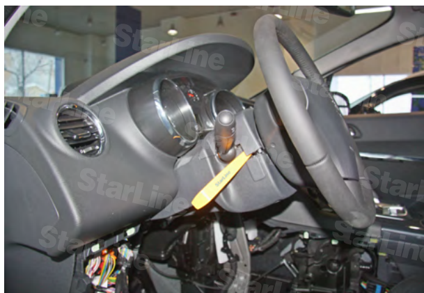
Фото 2.3. Снять верхнюю часть кожуха
