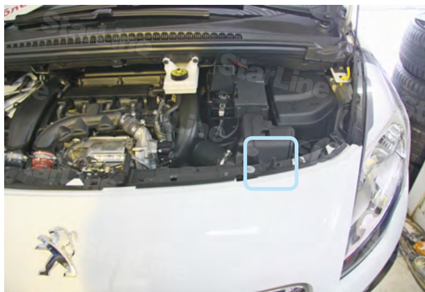
Фото 4.5. Возможное место установки концевика капота
