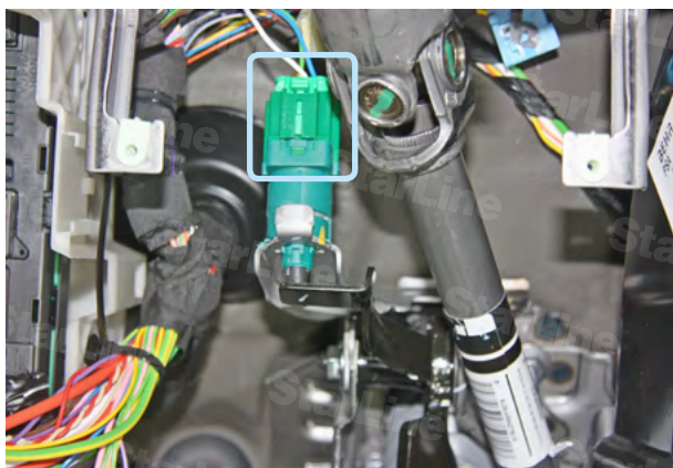
Фото 10.1. Местоположение разъёма педали тормоза
