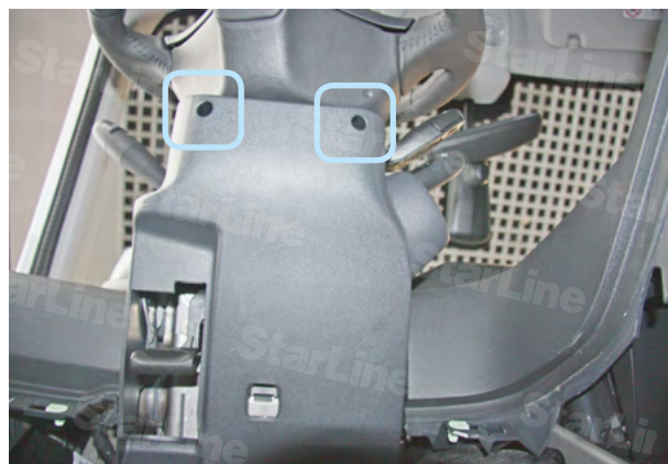
Фото 2.2. Саморезы крепления нижней части кожуха рулевого вала
