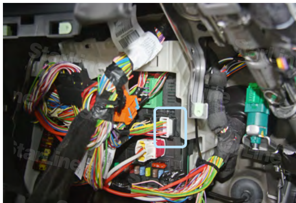
Фото 7.1. Местоположение разъёма на блоке BCM
