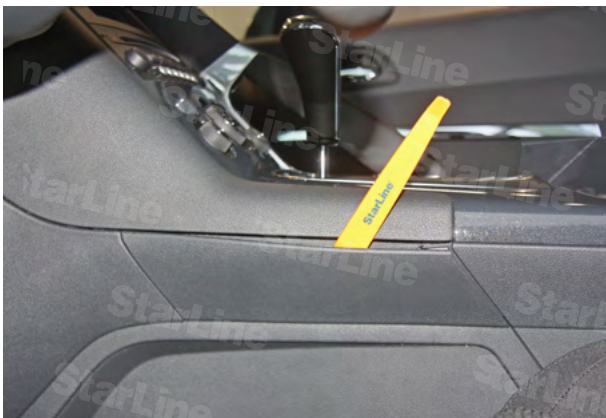
Фото 1.7. Снять декоративную панель
