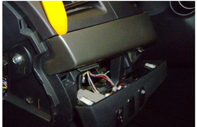
Снимите торцевую крышку пластиковым съемником.
