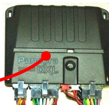
Возможное место для установки базовый блок системы Pandora - кронштейн центральной консоли над педальным узлом слева.
