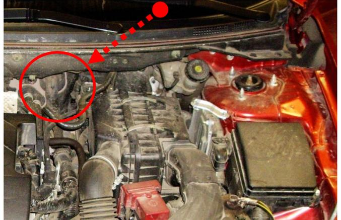
Рекомендуем протянуть провода в подкапотное пространство через резиновую заглушку в моторном щите над педальным узлом справа.
