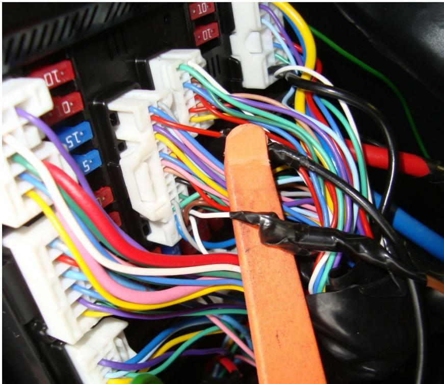
Стартер (+). Цвет провода КРАСНЫЙ. При подаче на этот провод +12В. У автомобиля включается стартер.
