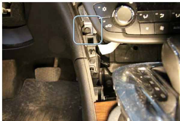
Фото 1.7. Крепление левой части центрального тоннеля
