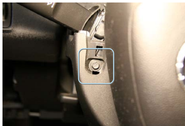
Фото 1.4. Крепление рулевого кожуха
