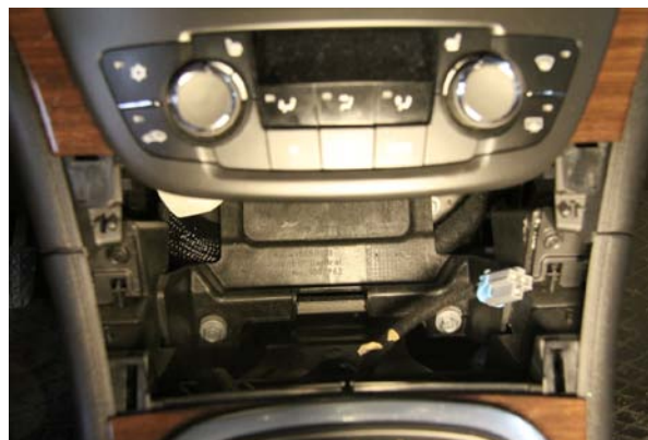
Фото 1.6. Снятие пепельницы. Крепление на защелках
