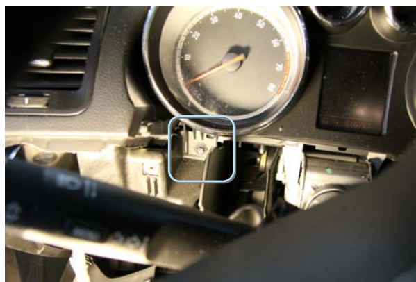
Фото 2.1. Крепление приборного щитка слева
