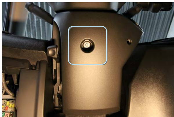
Фото 1.3. Крепление рулевого кожуха
