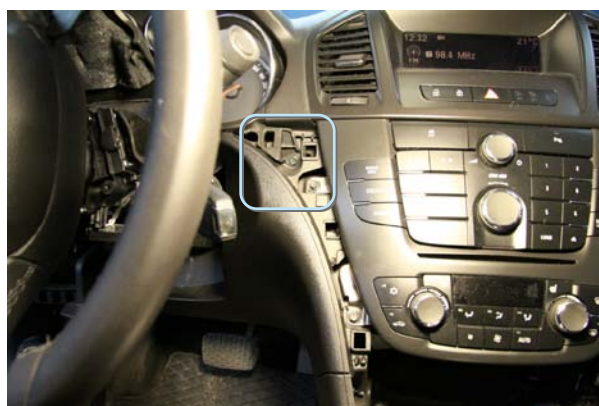
Фото 1.9. Снятие декоративной накладки (на защелках) и крепление подторпедника
