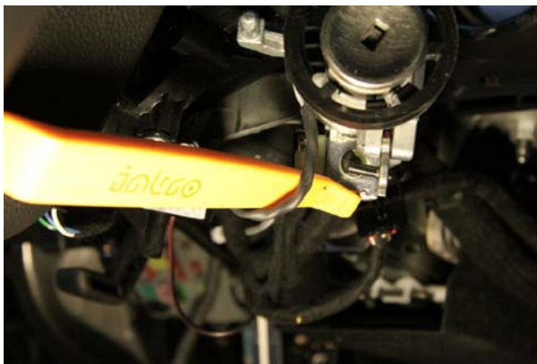
Фото 16. Провода рамки штатного иммобилайзера
