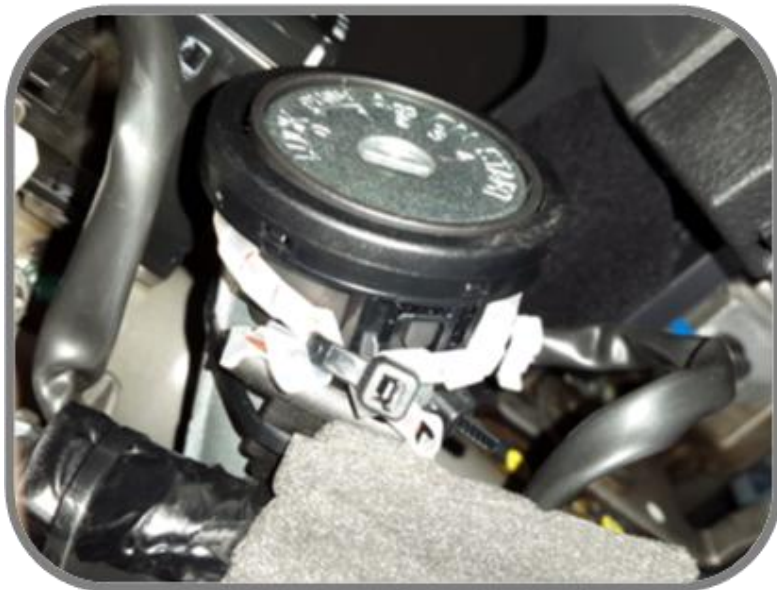
Рис. 6 расположение внешней рамки иммобилайзера
