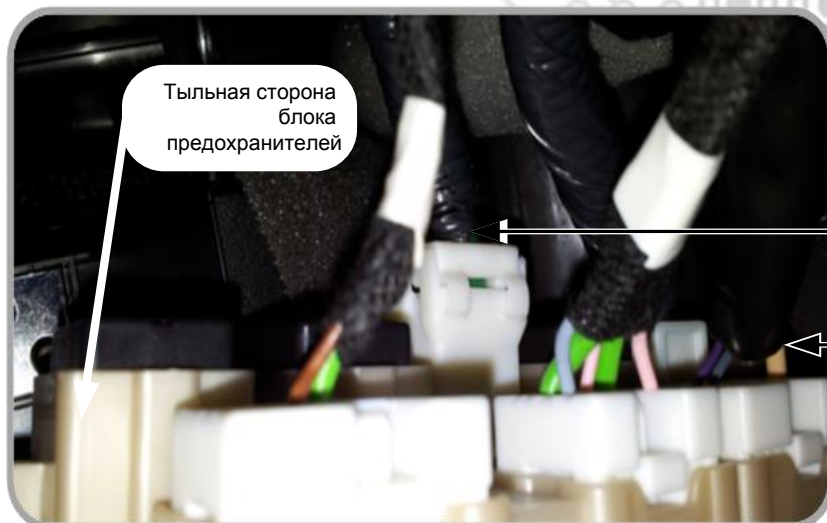
Рис.4 подключение плюса питания и контроля зажигания
