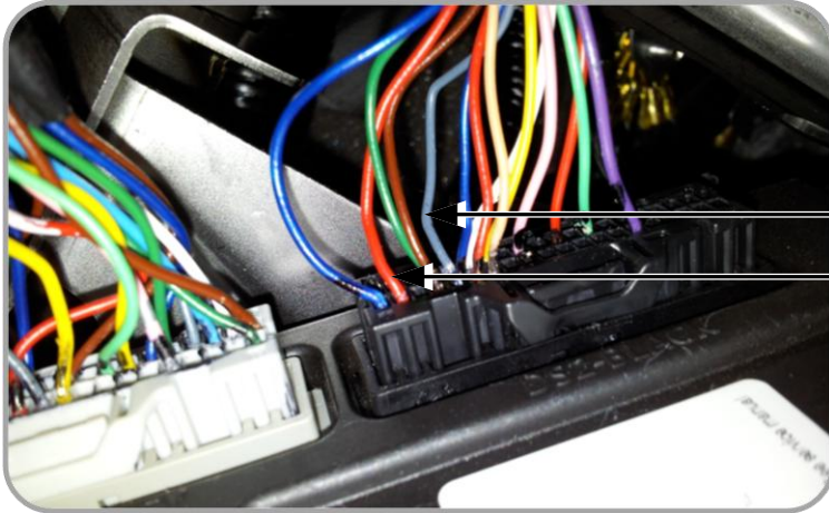
Рис.6 подключение цепей дистанционного запуска
