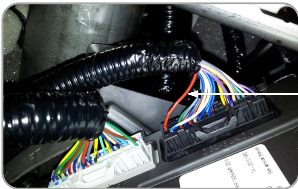
Рис. 9 Имитация нажатия кнопки старт-стоп.
