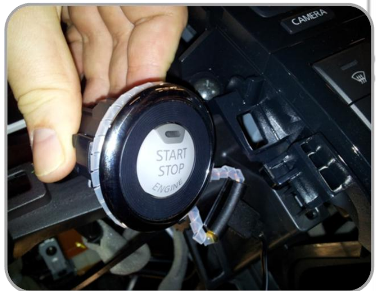
Рис.9 Расположение внешней антенны
