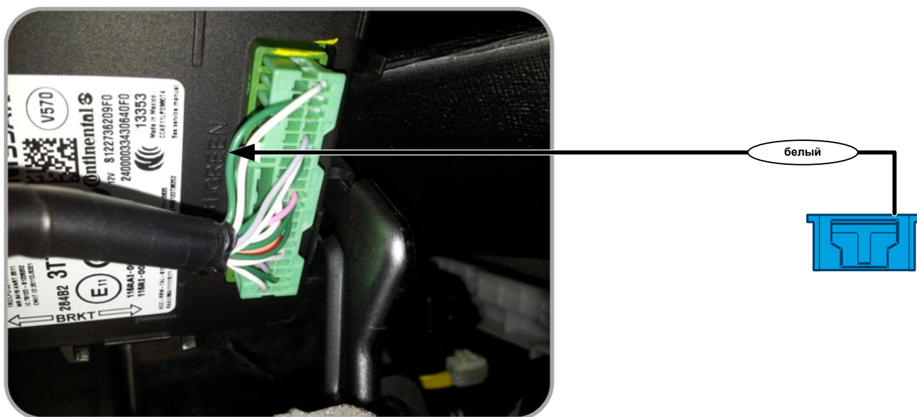
Рис.6 Имитация нажатия кнопки Start Stop
