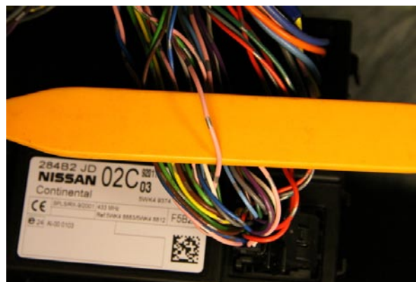
Фото 11.2. Ц.З. Закрытие — розовый
