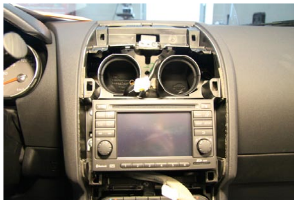
Фото 2.2. Демонтаж облицовки магнитолы
