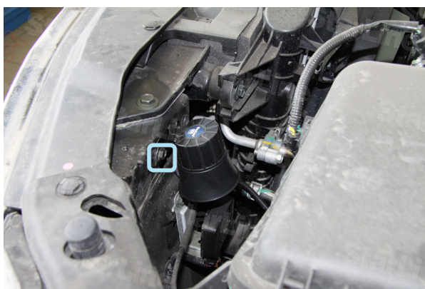
Фото 4.1. Сирена (крепление на штатную шпильку)
