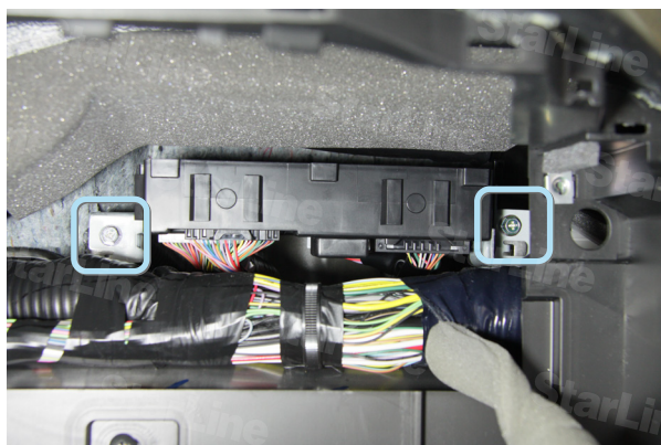
Фото 11.1. Саморезы крепления блока BCM
