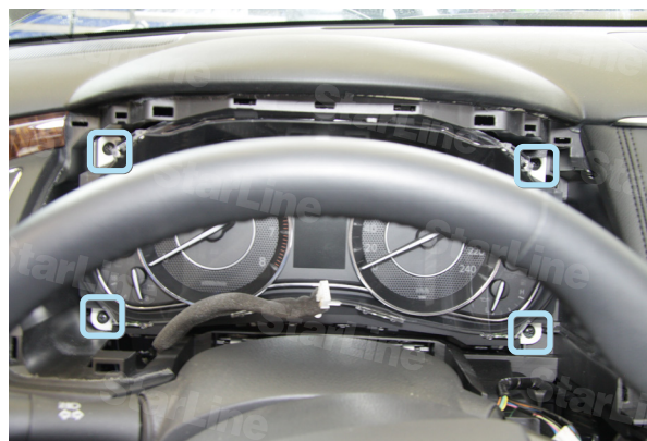
Фото 2.2. Саморезы крепления панели приборов
