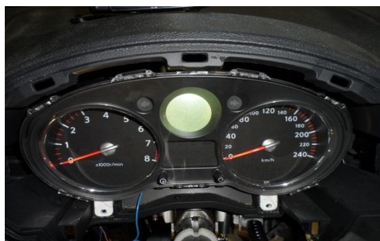
Открутить два самореза для демонтажа приборной панели.
