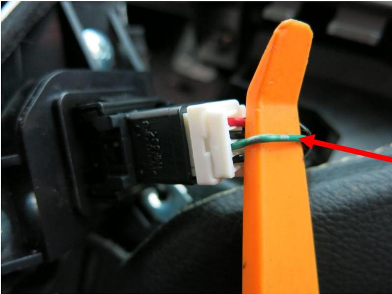
Световая сигнализация подключается к кнопке аварийки зелёный провод, управление по минусу потенциальное (заводская настройка Pandora управление импульсное).
