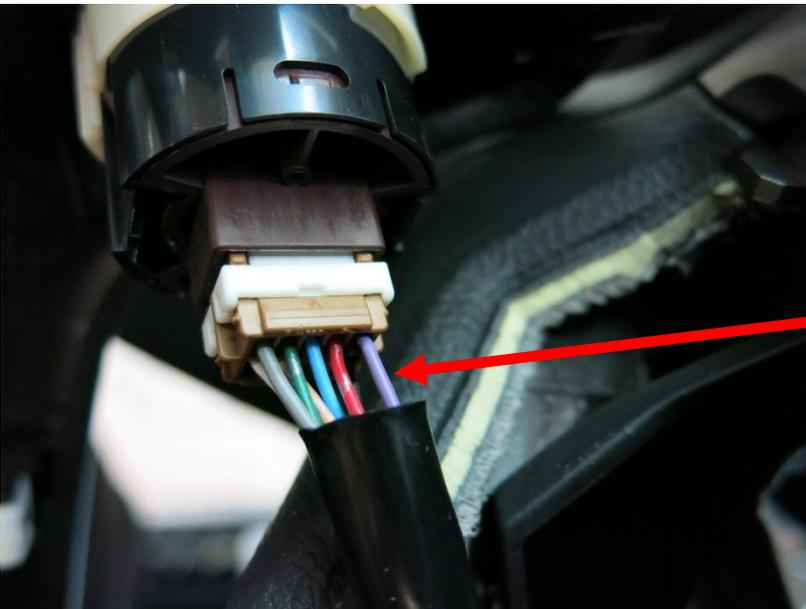
Подключите канал Зажигания 1 к фиолетовому проводу кнопки.
