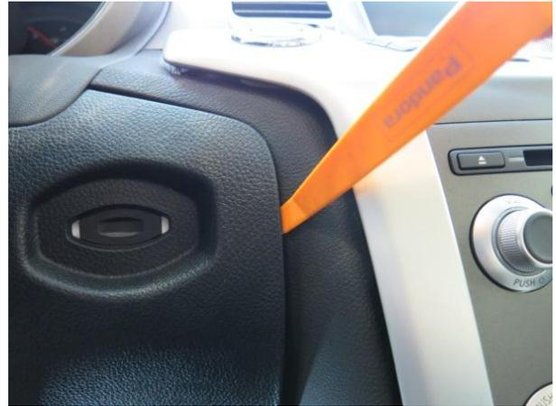
Кнопка START/STOP, для того что бы добраться для подключений к кнопке требуется снять пластиковую накладку на которой находится кнопка, снятие производить снизу так как сверху Накладка заходит крепежом за воздуховод.
