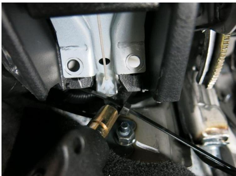
Для удобства монтажа снимите пластиковую накладку под рулём, для снятия открутите два самореза держащие ручку открывания капота, остальное крепление на пластиковых клипсах.
