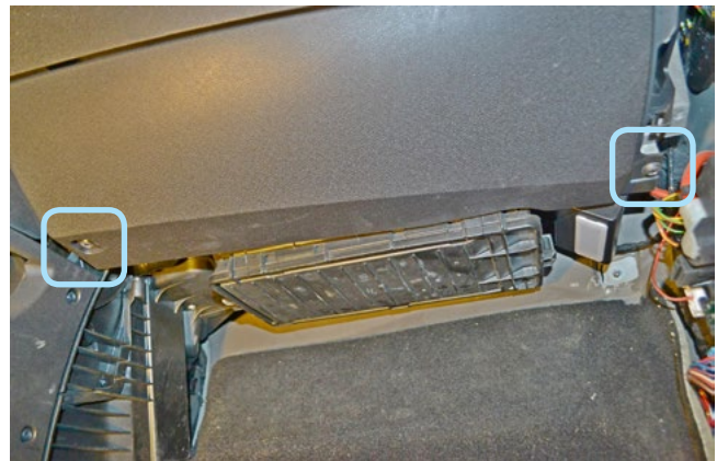
Фото 1.15. Саморезы крепления накладки под перчаточным ящиком
