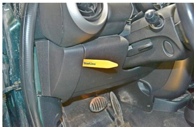
Фото 1.2. Снять левую накладку передней панели
