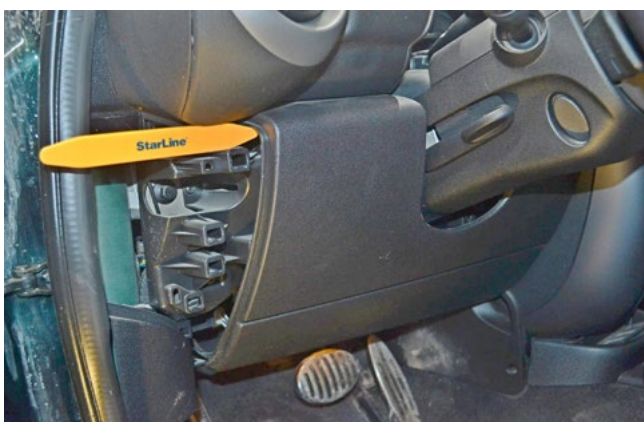
Фото 1.5. Снять накладку под рулевой колонкой
