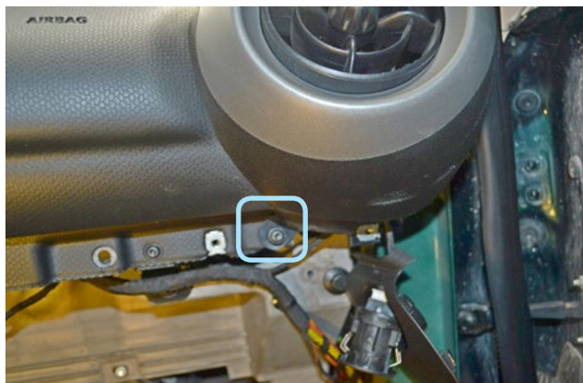
Фото 1.20. Саморез крепления накладки правого воздуховода
