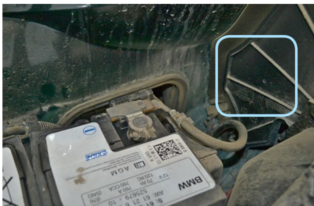
Фото 2.7. Возможное место установки сирены
