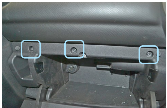
Фото 1.17. Саморезы крепления перчаточного ящика
