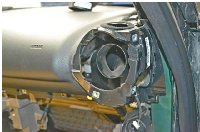
Фото 1.22. Накладка правого воздуховода снята
