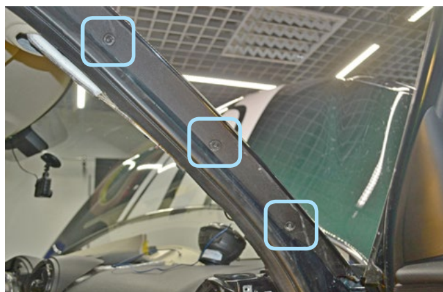
Фото 2.2. Саморезы крепления накладки
