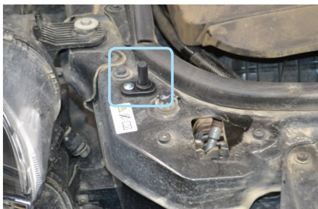
Фото 2.11. Возможное место установки концевика капота
