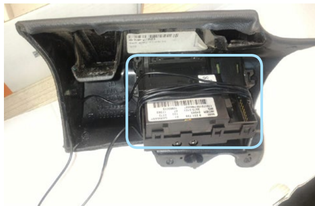
Фото 3.12. Расположение антенны модуля BP-03 на слоте ключа
