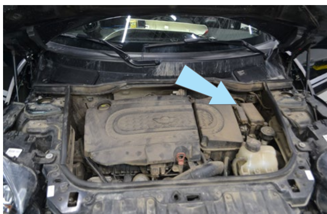
Фото 2.13. Возможное место установки подкапотного блока R6
