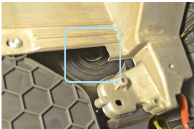
Фото 2.12. Штатный уплотнитель. Вид со стороны салона
