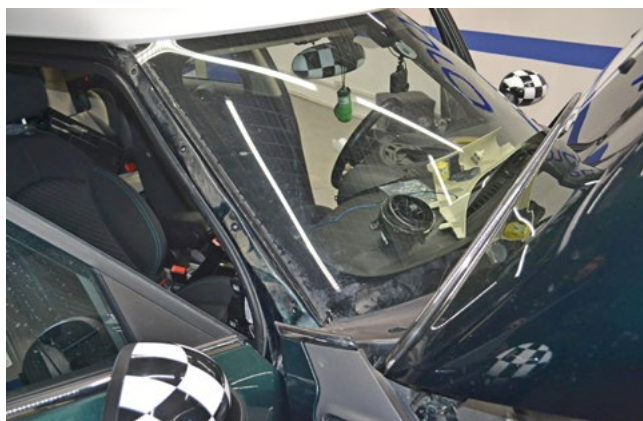
Фото 2.3. Наружная накладка передней правой стойки снята
