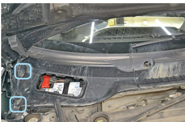
Фото 2.5. Гайки крепления накладке под правым дворником
