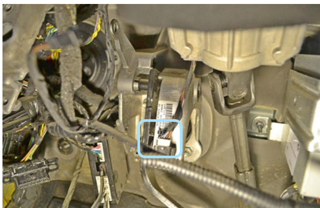
Фото 3.7. Местоположение разъёма педали тормоза
