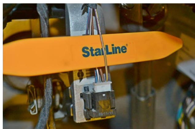
Фото 3.10. Концевик педали тормоза (фиолетово-жёлтый)
