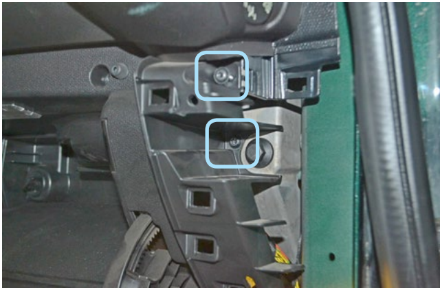
Фото 1.18. Саморезы крепления перчаточного ящика
