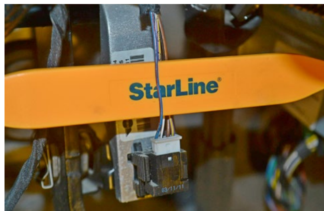
Фото 3.8. Концевик педали тормоза (сине-красный)
