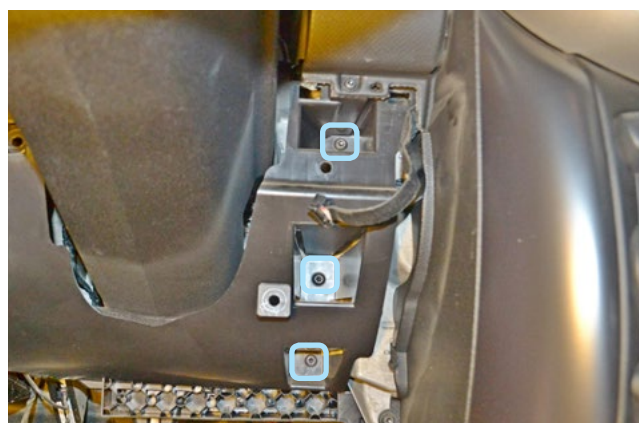
Фото 1.8. Саморезы крепления внутренней накладке под рулевой колонкой
