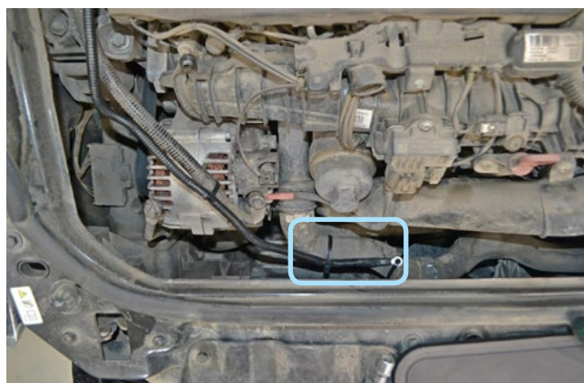
Фото 2.9. Место установки датчика температуры двигателя
