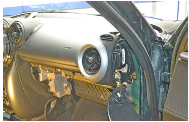
Фото 1.19. Перчаточный ящик снят
