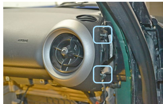
Фото 1.21. Саморезы крепления накладки правого воздуховода
