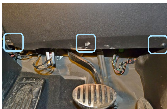
Фото 1.4. Саморезы крепления накладки под рулевой колонкой
