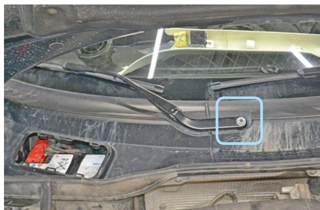
Фото 2.4. Гайка крепления переднего правого дворника
