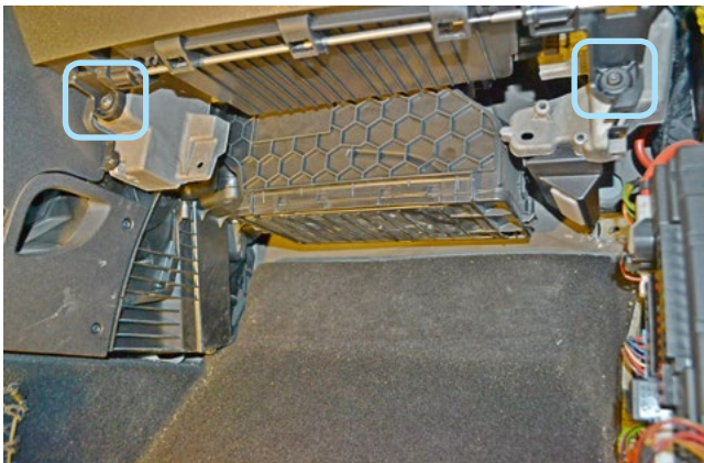
Фото 1.16. Саморезы крепления перчаточного ящика
