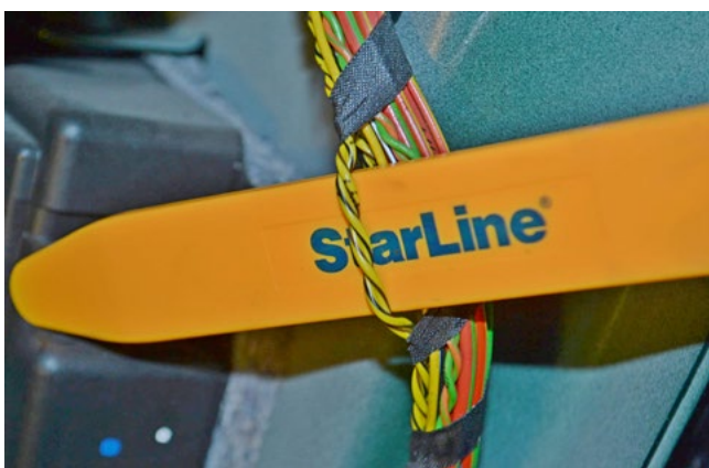
Фото 3.4. Шина CAN-B (жёлто-чёрный и жёлто-коричневый)
