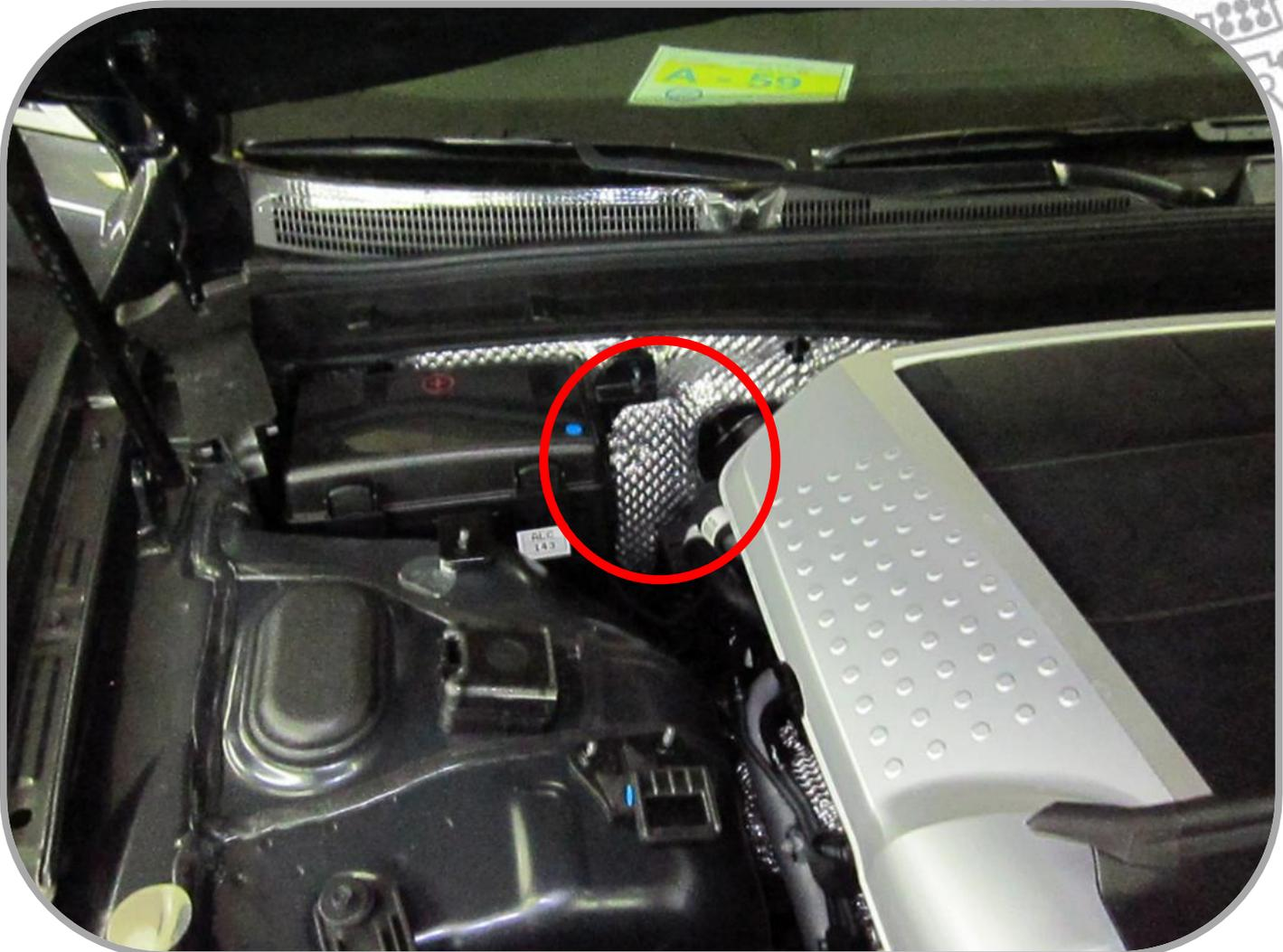
Рис.8 Возможное место установки сирены.
