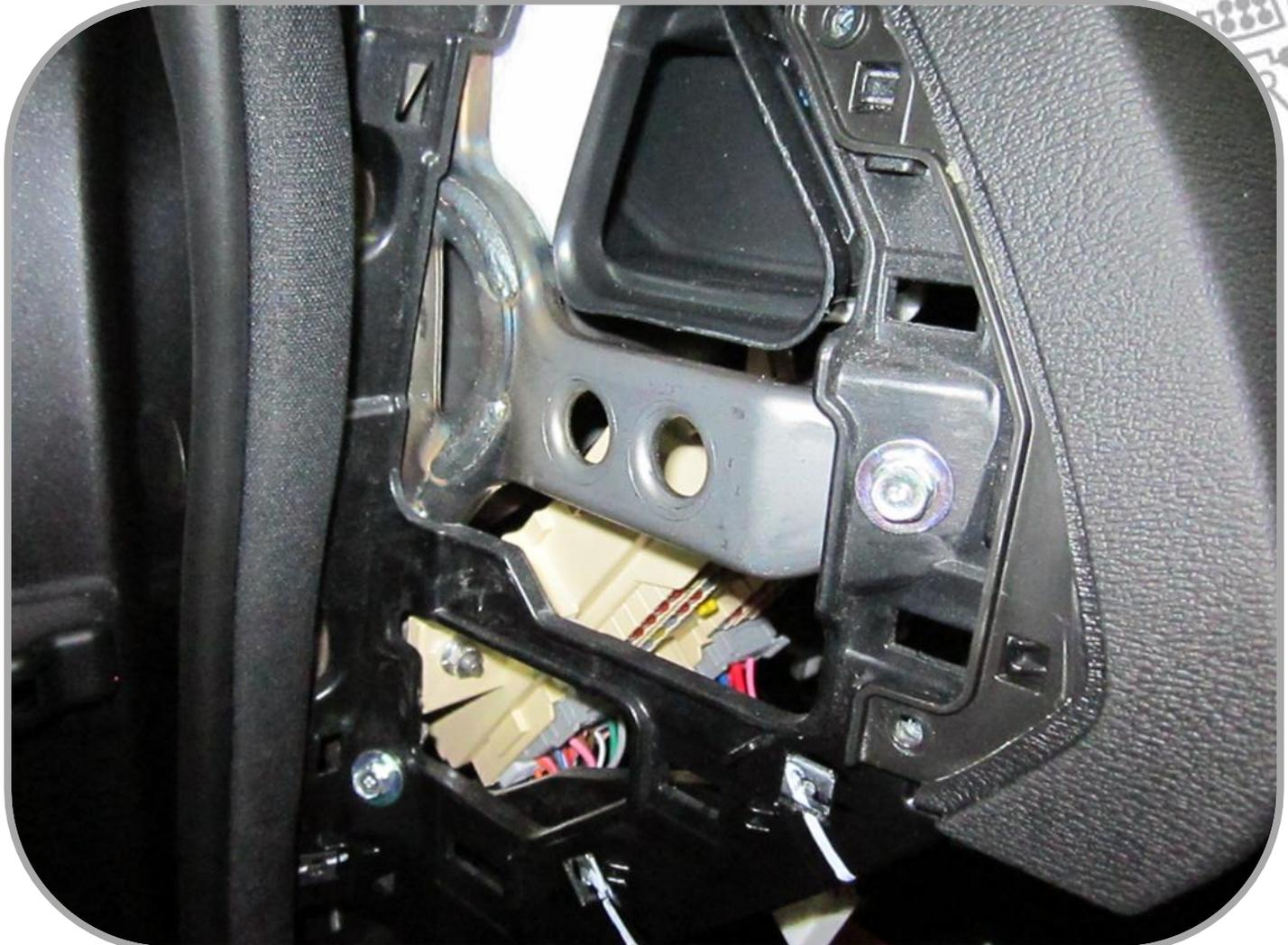
Рис.7 Возможное место установки датчика удара.
