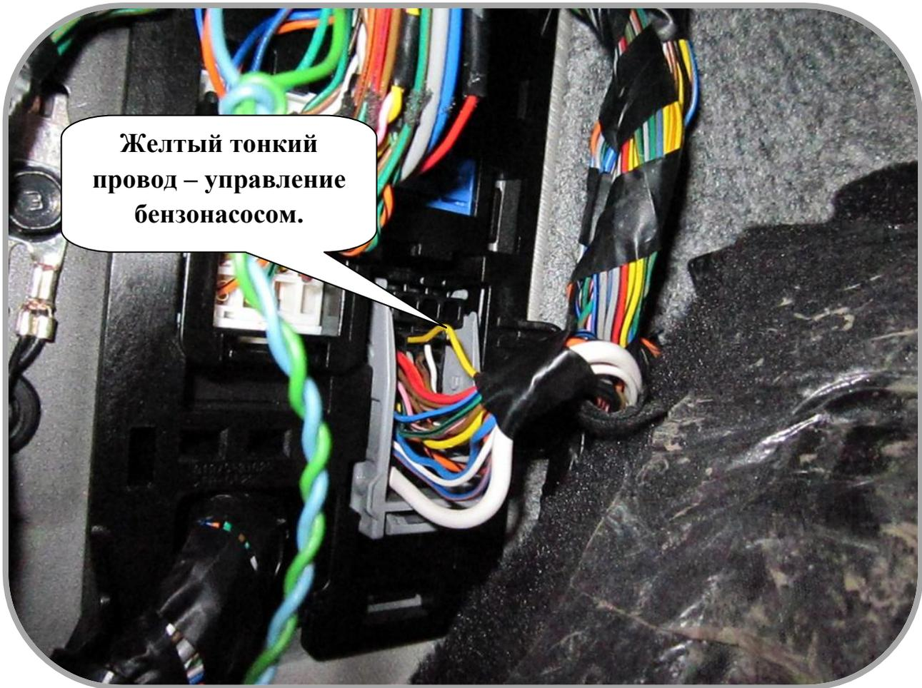
Рис.5 Расположение провода питания бензонасоса.
