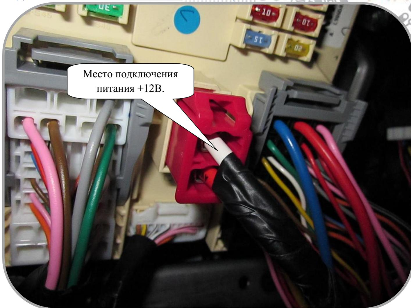
Рис. 9 Подключение провода питания системы.
