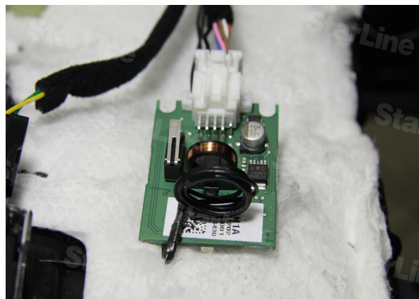
Фото 8.2. Положение антенны модуля обхода иммобилайзера BP-03
