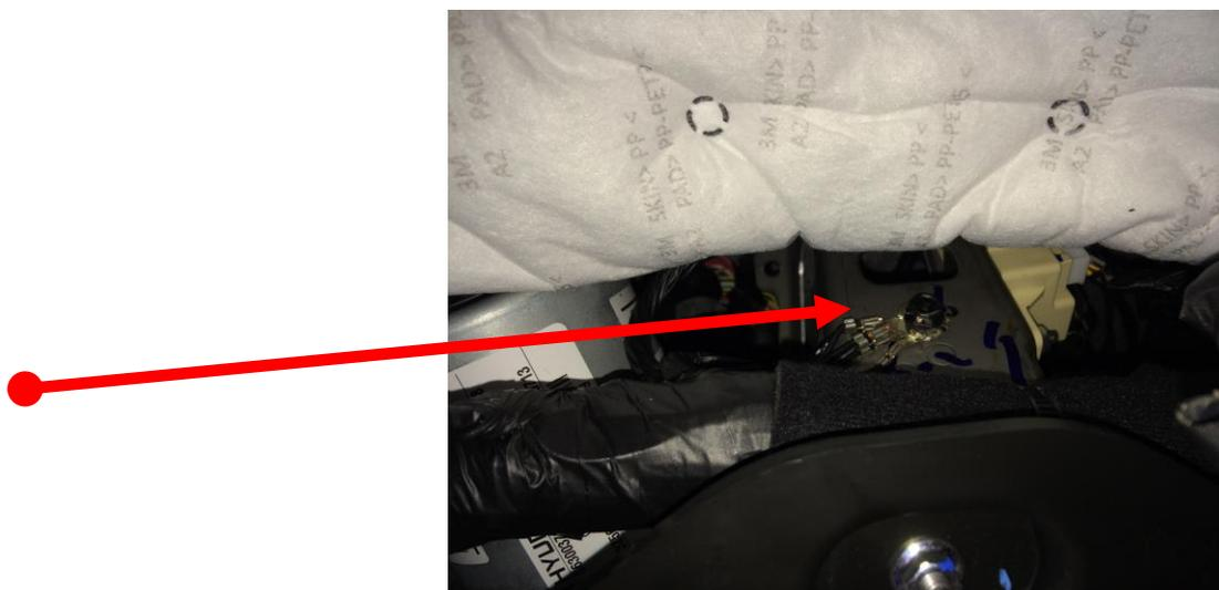
Прикрепите базовый блок системы Pandora за приборной панелью.
