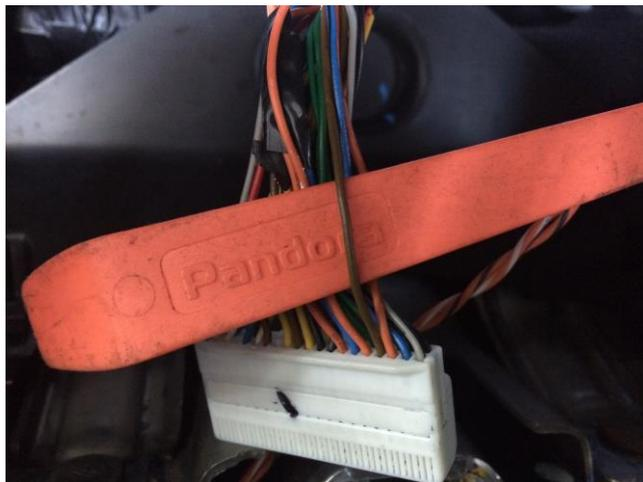
Коричнево-черный провод INP4(+) Pandora подключить к коричневому проводу в жгуте приборной панели автомобиля.
