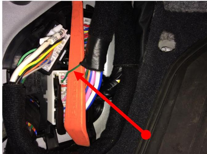
Подключение производится в кик панели водителя.
