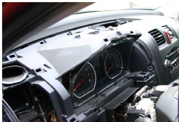
Фото 3.2. Снятие верхней накладки торпеды
