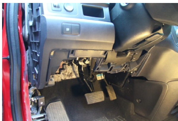
Фото 1.1. Снятие подторпедника. Общий вид
