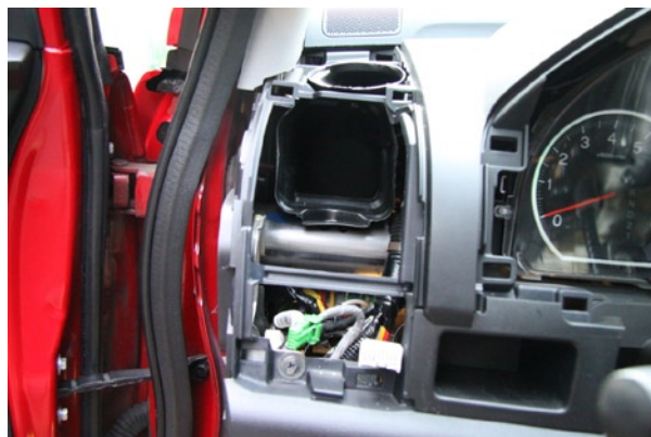
Фото 3.1. Снятие левого воздуховода
