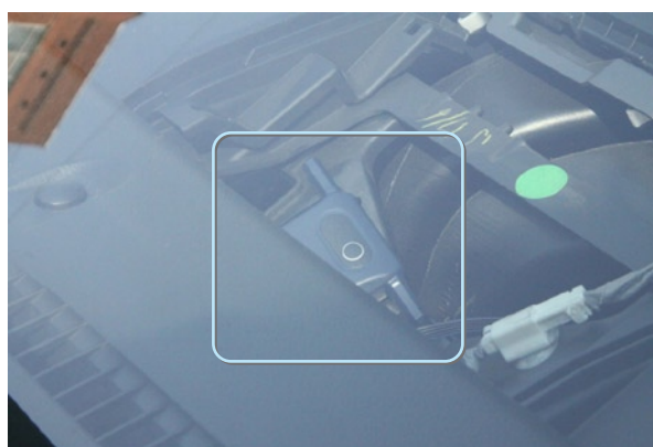
Фото 4.4. Антенна под накладкой торпеды
