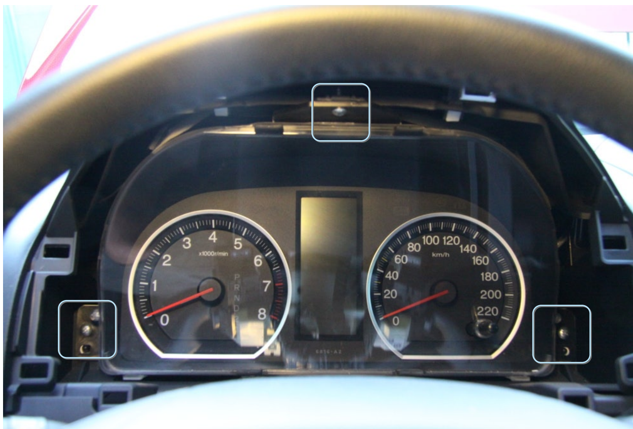
Фото 2. Снятие облицовки и крепление приборного щитка
