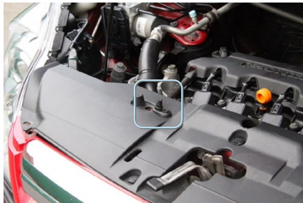
Фото 5.1. Концевик капота. Отрезать 2 деления.
