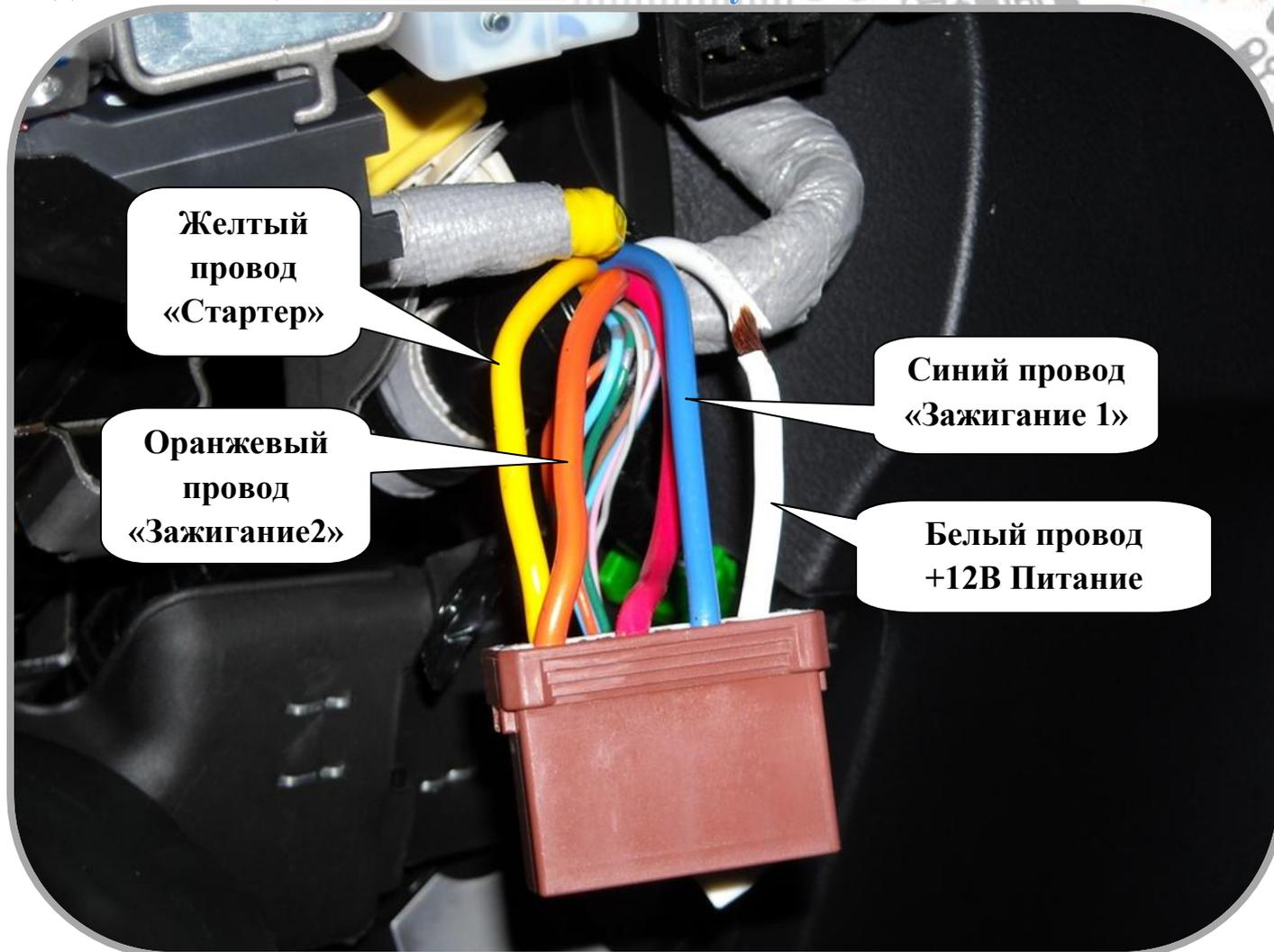
Рис.4 Разъем замка зажигания.
