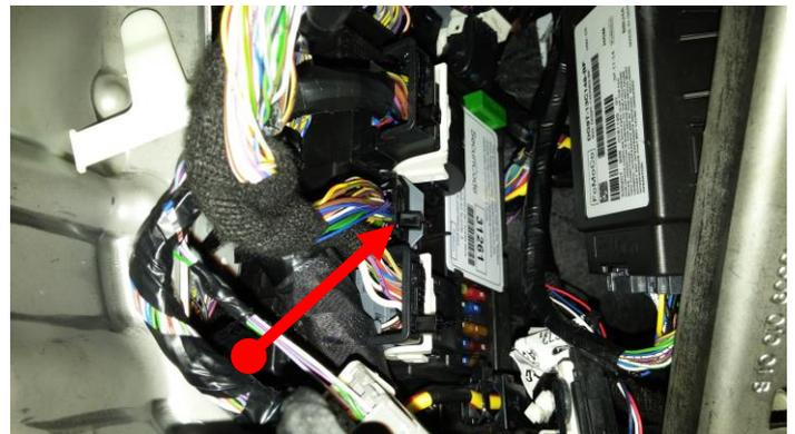
Световая сигнализация подключается к кнопке аварийки, жгут среднего черного разъема блока ВСМ 19 контакт, коричнево желтый провод (0.3мм) управление по минусу.
