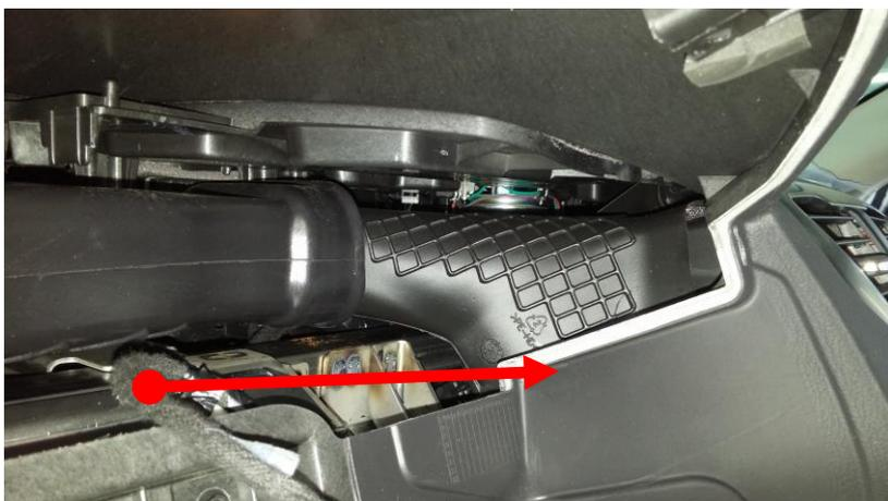
Прикрепите базовый блок системы Pandora за приборной панелью.
