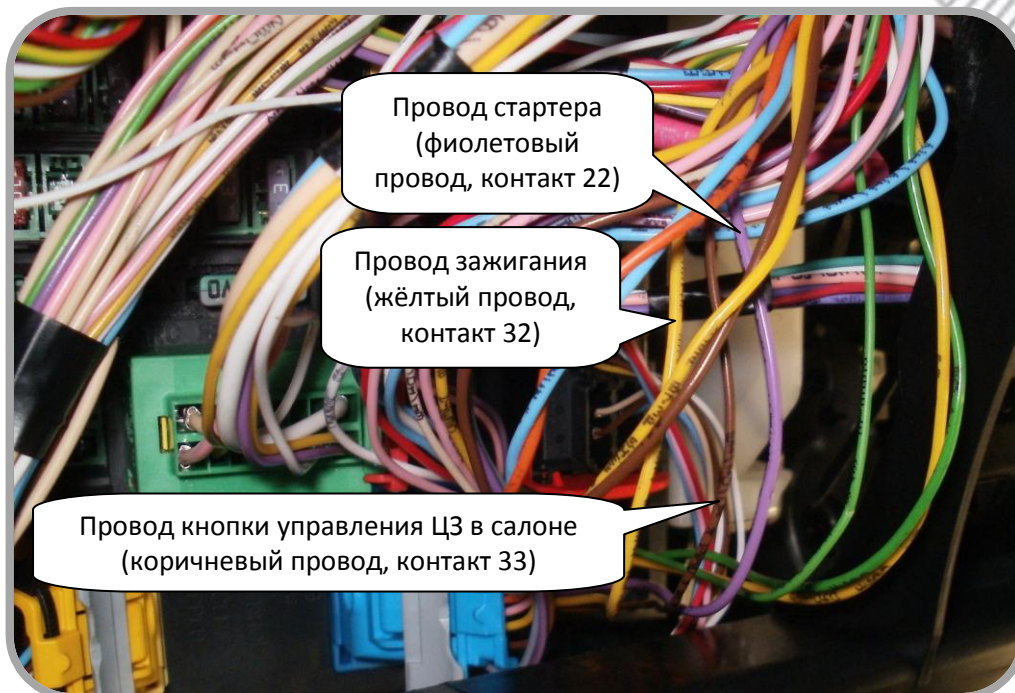
Рис. 2а: Подключения датчика зажигания и управления закрытием ЦЗ по кнопке.
