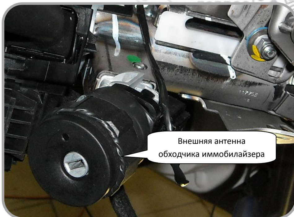
Рис. 6: Установка внешней антенны обходчика.
