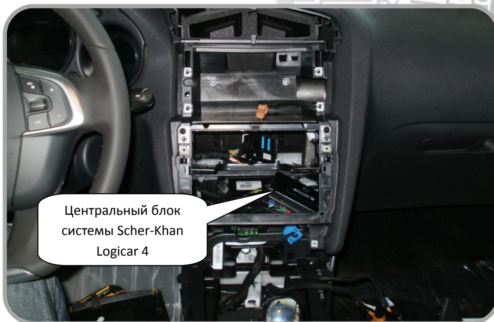
Рис. 8а: Возможное место установки центрального блока.
