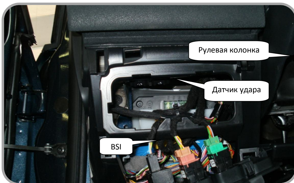
Рис. 7: Возможное место установки датчика удара.
