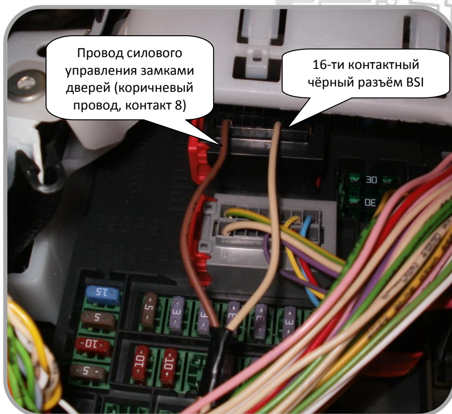
Рис. 4: Подключение ЦЗ по варианту 2
