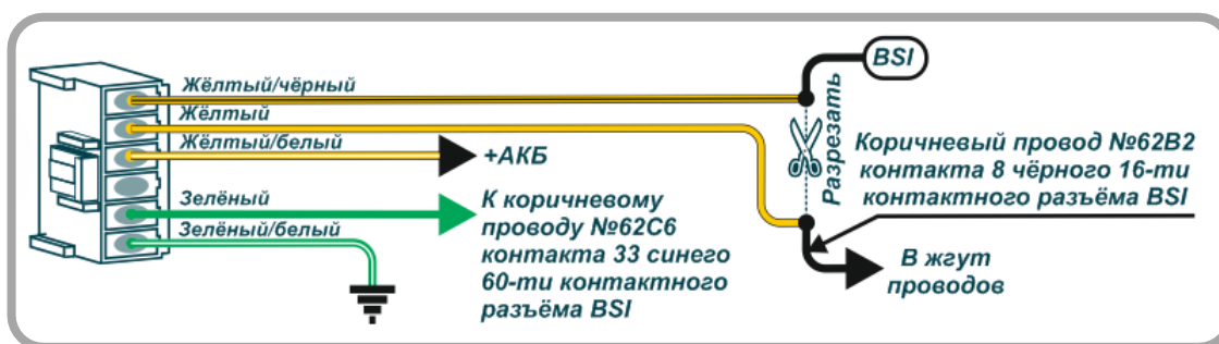
Схема 2: Подключение ЦЗ по варианту 2.
