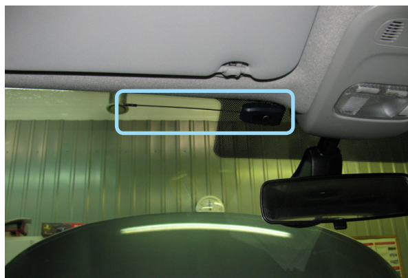
Фото 4.2. Место установки антенны
