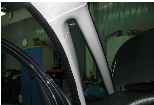
Фото 3.1. Снятие накладки стойки лобового стекла
