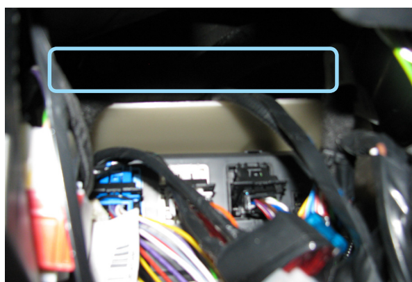
Фото 9.1. Место установки основного блока
