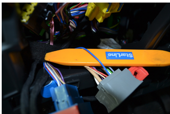
Фото 13.2. Подключение центрального замка. Pin 13 (синий)
