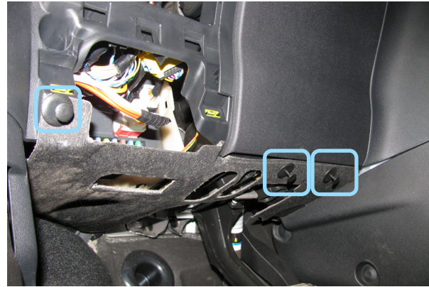
Фото 1.2. Крепление нижней части
