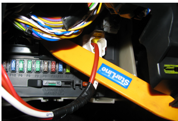
Фото 17. Подключение постоянного питания
