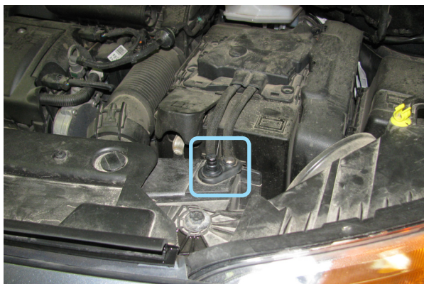
Фото 7. Место установки концевика капота
