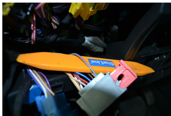
Фото 13.3. Подключение центрального замка. Pin 15 (серый)
