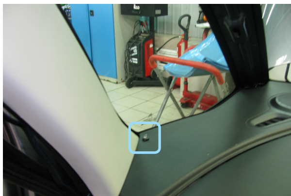
Фото 4.1. Место установки светодиода
