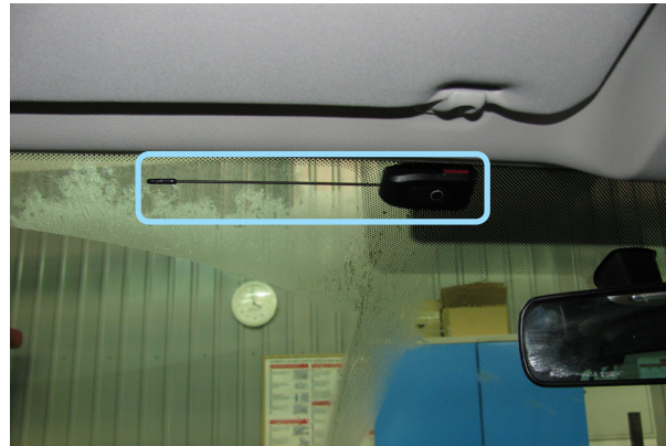
Фото 4.2. Место установки антенны
