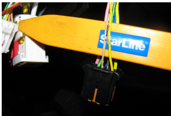
Фото 12.1. Подключение CAN-A. CAN-H pin 8 (бежевый), CAN-L pin 10 (жёлтый).
