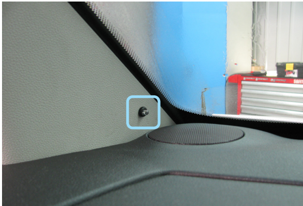
Фото 4.1. Место установки светодиода
