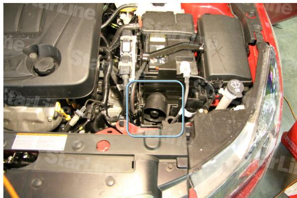
Фото 5.1. Сирена (крепление двумя саморезами)
