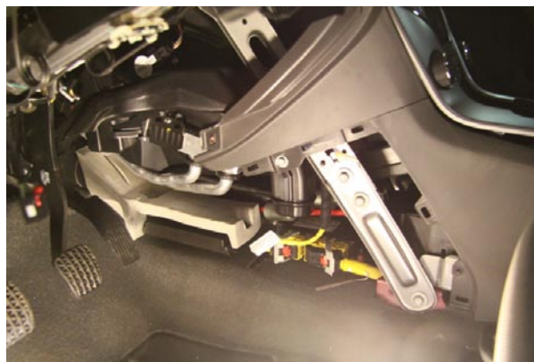
Фото 3.1. Снятие левой накладки
