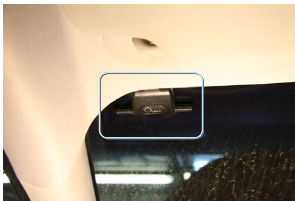
Фото 7.2. Антенна на лобовом стекле
