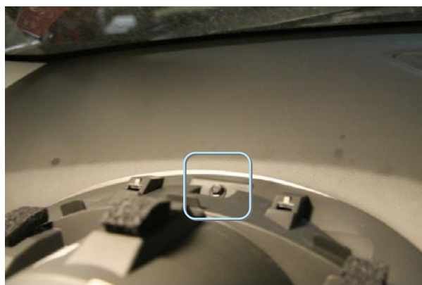
Фото 4.3. Саморез крепления приборного щитка
