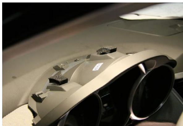
Фото 4.2. Снятие декоративной накладки
