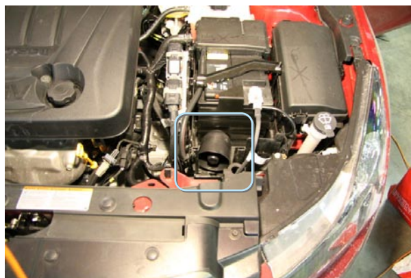
Фото 5.1. Сирена (крепление двумя саморезами)
