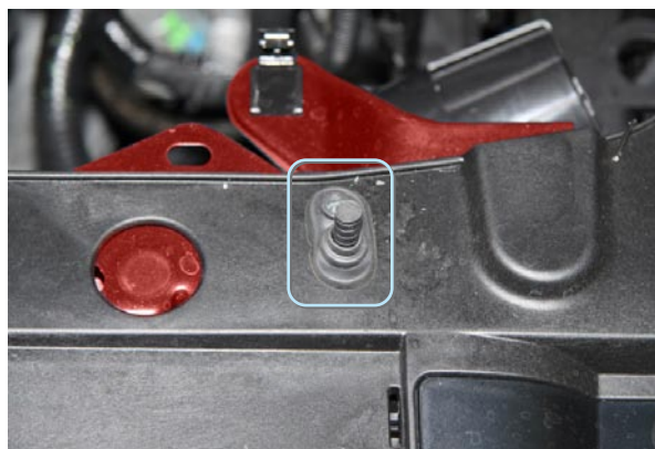
Фото 5.2. Концевик капота (отрезать 1,5 деления)
