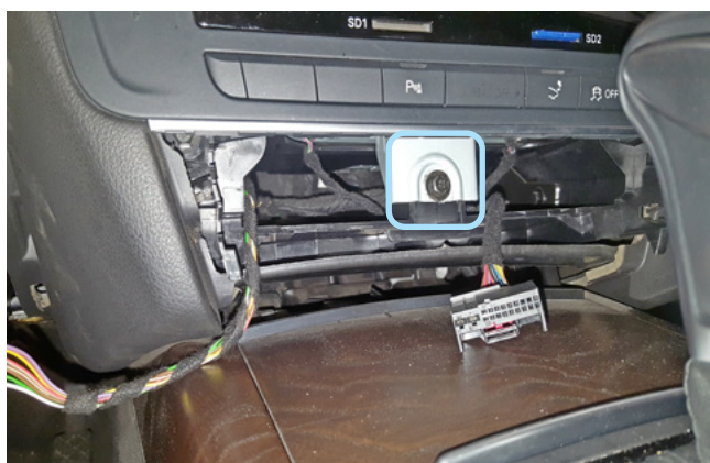
Фото 1.13. Болт крепления мультимедийной системы
