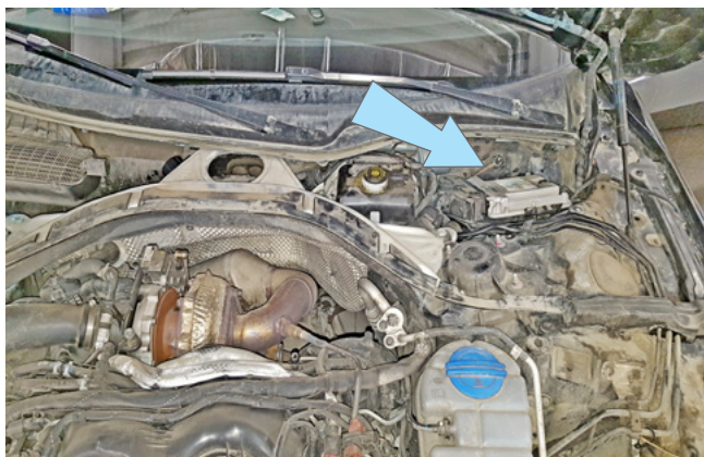
Фото 2.7. Возможное место установки подкапотного блока R6
