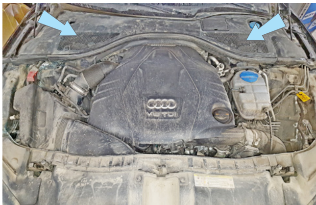
Фото 2.1. Накладка под дворниками. Общий вид
