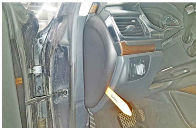
Фото 1.2. Снять боковую накладку передней панели
