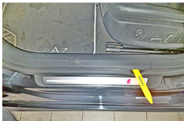
Фото 1.9. Снять наклейку порога двери водителя
