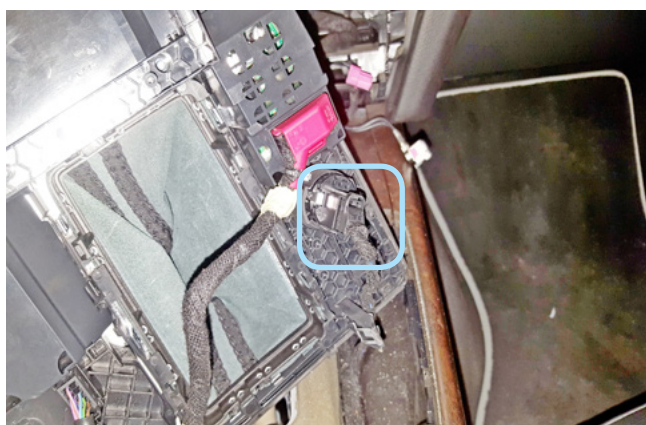
Фото 3.5. Местоположение разъёма кнопки Старт-Стоп
