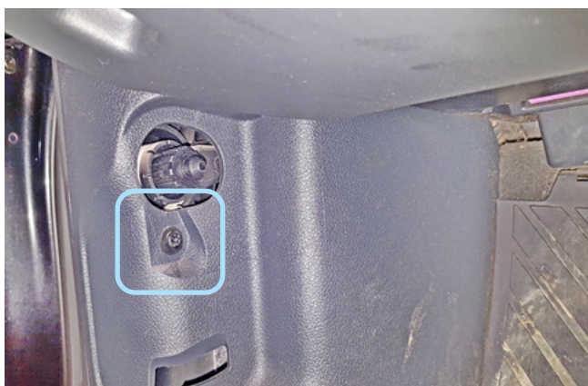
Фото 1.8. Саморез крепления наклейки порога двери водителя
