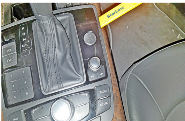
Фото 1.15. Снять накладку ручки селектора АКПП
