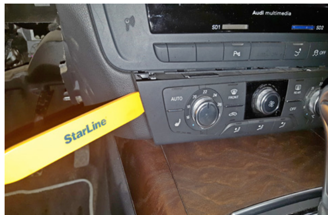
Фото 1.12. Снять блок управления системой климат-контроля
