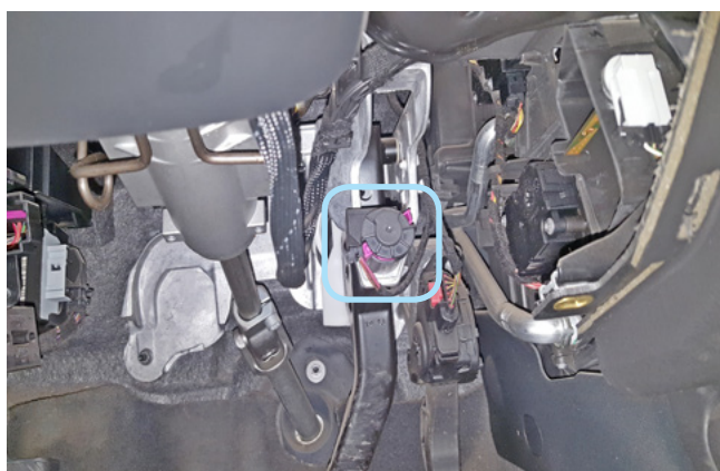
Фото 3.7. Местоположение разъёма концевика педали тормоза
