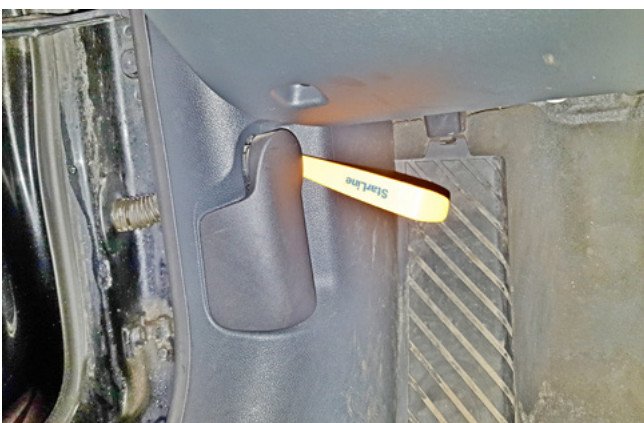
Фото 1.5. Снять ручку отпирания капота
