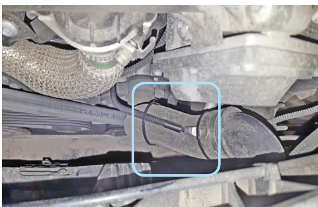
Фото 2.5. Крепление датчика температуры двигателя
