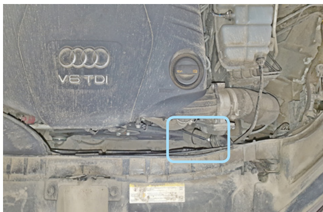
Фото 2.4. Место установки датчика температуры двигателя
