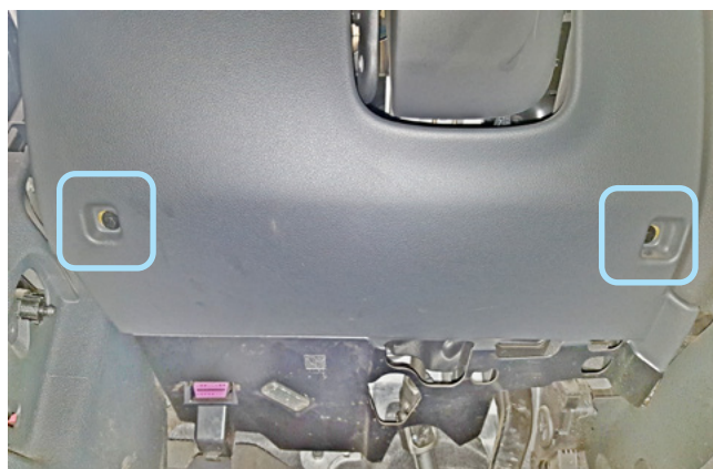
Фото 1.6. Саморезы крепления накладки снизу
