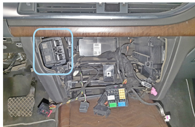
Фото 1.14. Местоположение антенны штатного иммобилайзера
