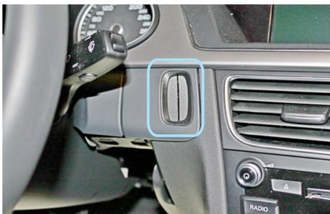
Фото 1.5. Слот ключа для запуска двигателя
