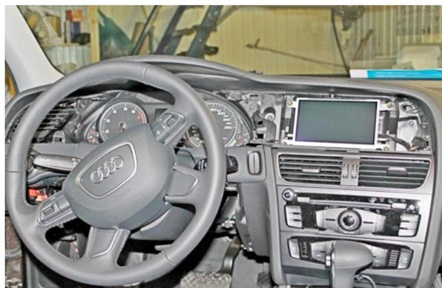
Фото 1.7. Накладка панели приборов снята
