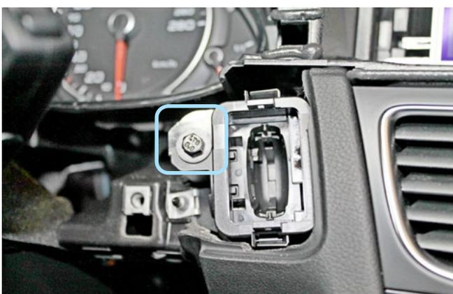
Фото 1.10. Накладка снята. Саморез крепления слота
