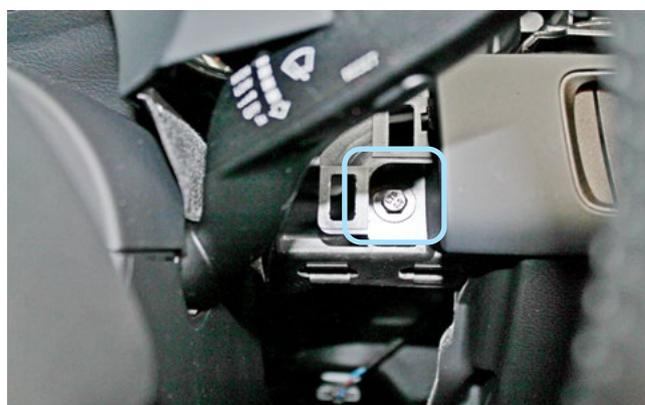
Фото 1.9. Накладка снята. Саморез
