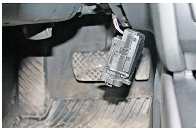
Фото 1.11. Слот ключа для запуска двигателя снят
