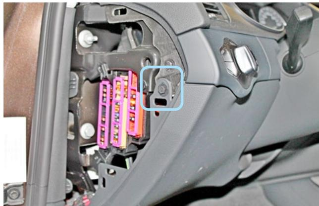
Фото 1.2. Боковая накладка снята. Саморез
