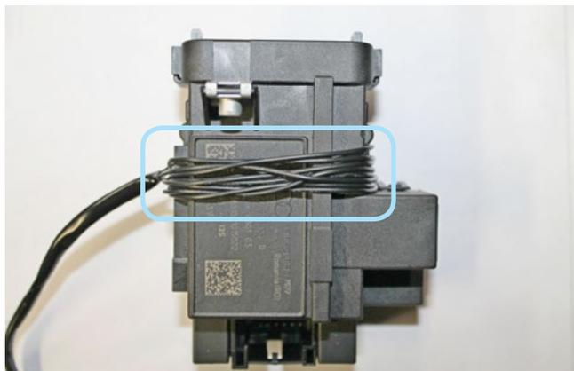
Фото 3.8. Расположение антенны модуля VP-03 на слоте ключа
