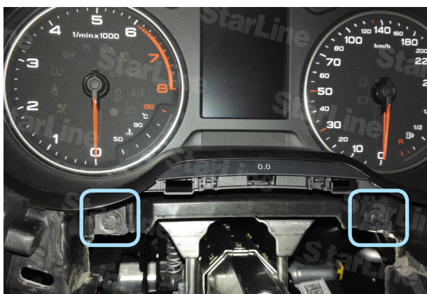
Фото 3.3. Болты крепления панели приборов
