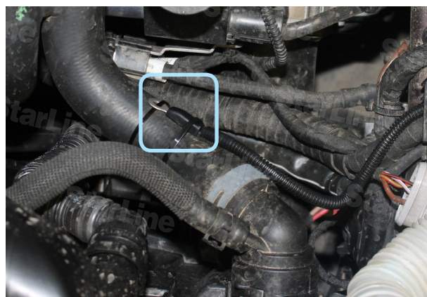
Фото 6.2. Крепление датчика температуры двигателя
