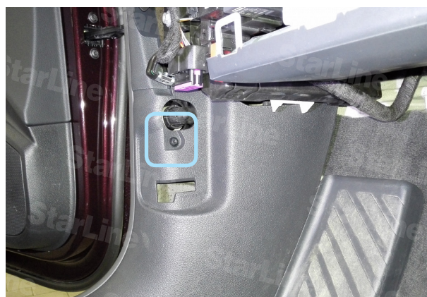
Фото 2.4. Саморез крепления кик-панели
