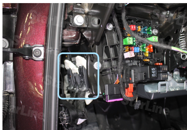
Фото 2.6. Местоположение блока VCM
