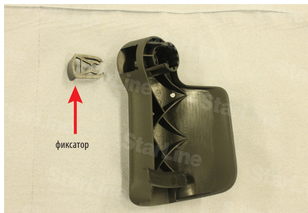
Фото 2.2. Ручка открытия капота снята
