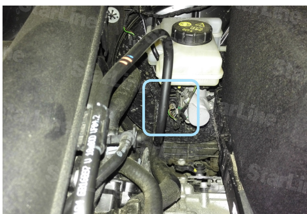
Фото 6.7. Местоположение концевика педали тормоза
