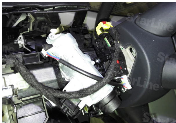
Фото 4.4. Нижняя часть кожуха рулевого вала снята
