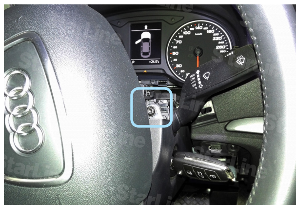
Фото 4.2. Саморез крепления нижней части кожуха рулевого вала справа
