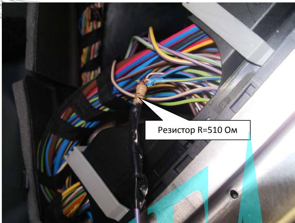
Рис. 5: Имитация открытия водительской двери.
