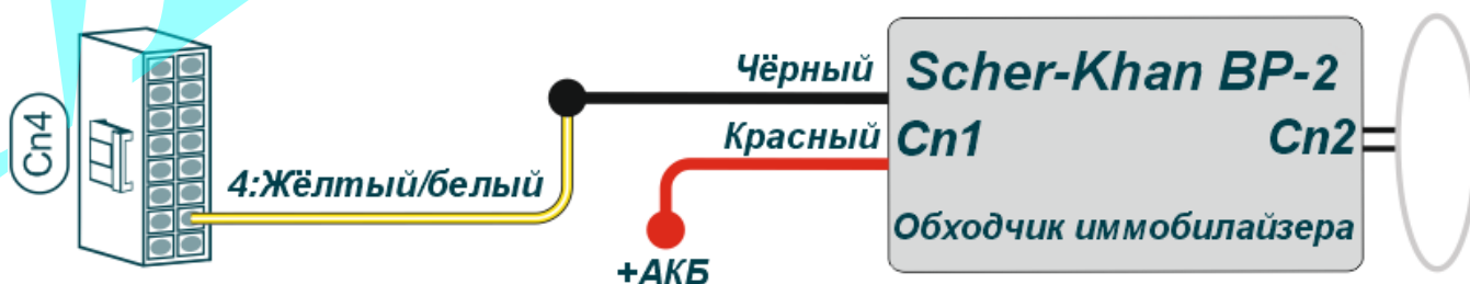
Схема. 4: Подключение обходчика иммобилайзера.
