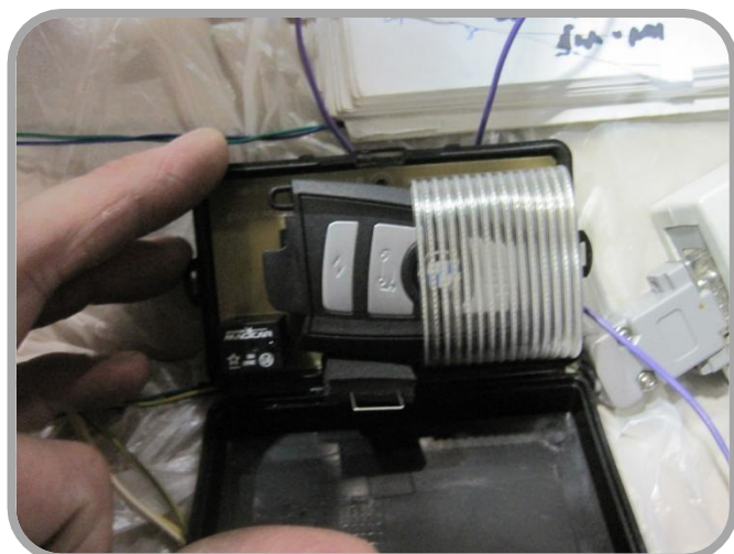
Рис.5: Ключ в обходчике иммобилайзера.
