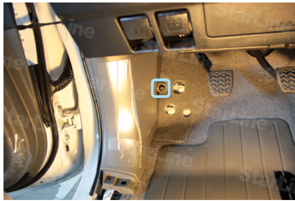
Фото 1.2. Подставка для ступни снята; клипса
