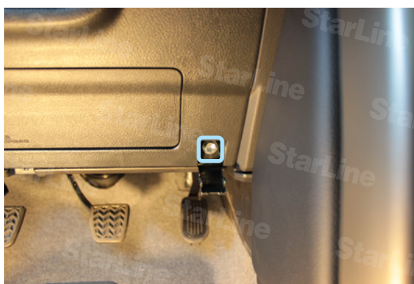
Фото 1.6. Болт М6 рулевого кожуха
