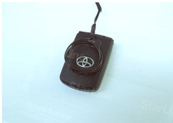
Фото 10.4. Расположение рамки для обхода иммобилайзера на ключе
