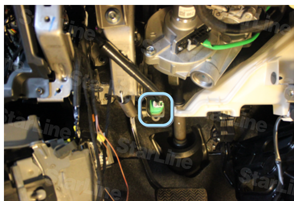
Фото 4.4. Местоположение разъема концевика педали тормоза
