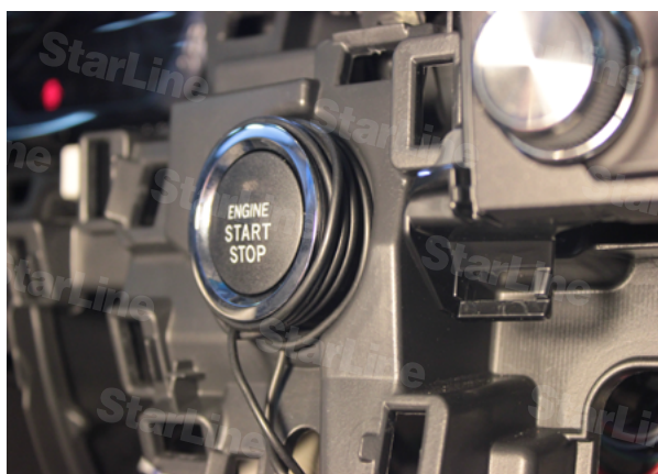
Фото 10.3. Расположение рамки для обхода иммобилайзера на кнопке Старт-Стоп
