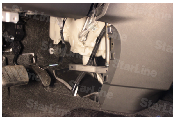
Фото 3.2. Нижняя левая накладка центральной консоли снята
