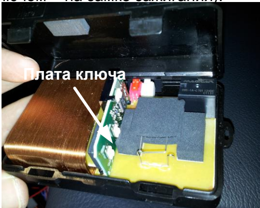
Расположение платы ключа в обходчике иммобилайзера BP-3
