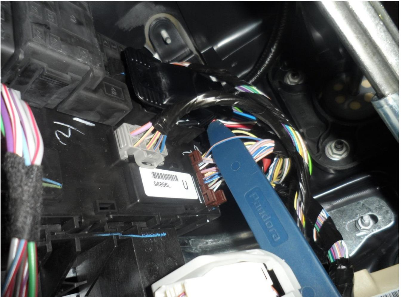
Сине-оранжевый провод. На нём появляется +12В. при открытии капота. Поэтому необходимо изменить в настройках концевиков полярность входа концевика капота на положительную.
