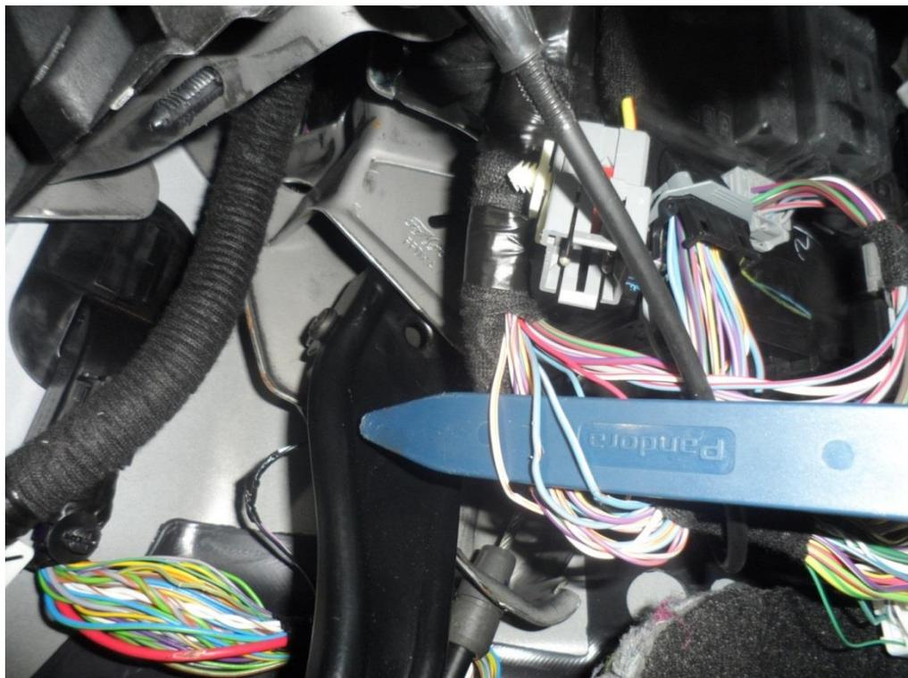
Или в разъеме замка зажигания, для удобства замок демонтируется ,крепится на пластиковых защелках
