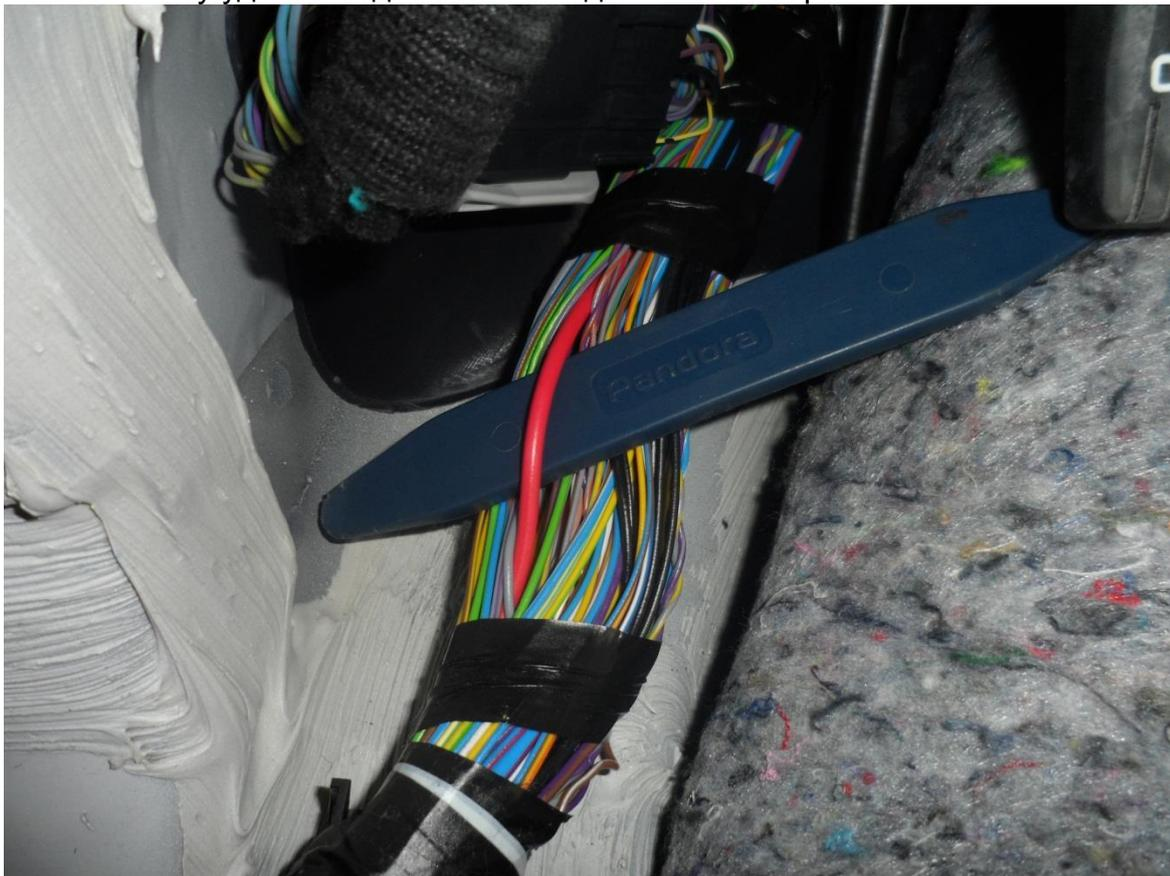
Отрицательный провод питания сигнализации необходимо подключить к массовому проводу автомобиля.
