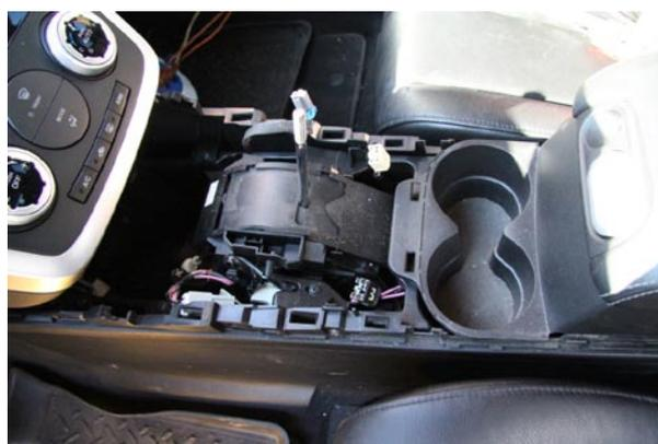
Фото 1.3. Демонтаж горизонтальной части тоннеля
