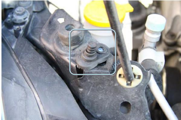
Фото 6.3. Концевик капота. Отрезать 2 деления
