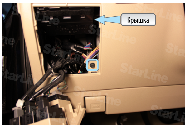
Фото 1.4. Панель с кнопками снята; саморез крепления подторпедника и крышка кармана
