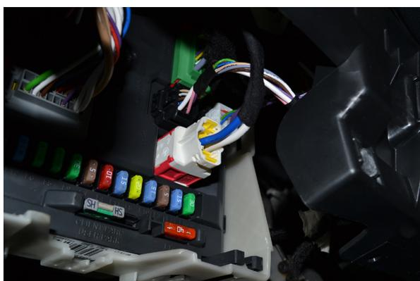
*Фото 17.1. Блок BSI, разъём AP*
