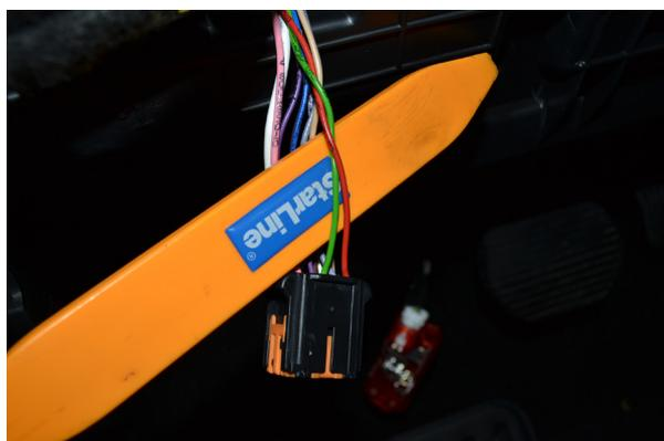
Фото 12.1. Подключение CAN-A. CAN-H pin 8 (зелёный), CAN-L pin 10 (красный).
