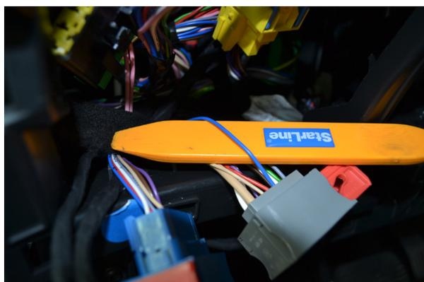
Фото 13.2. Подключение центрального замка. Pin 13 (синий)
