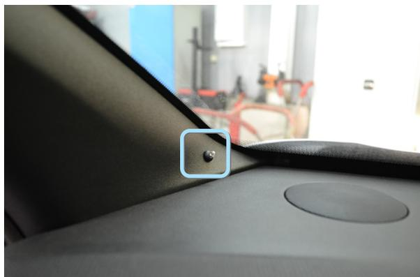
Фото 4.1. Место установки светодиода
