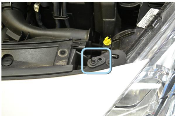
Фото 7. Место установки концевика капота
