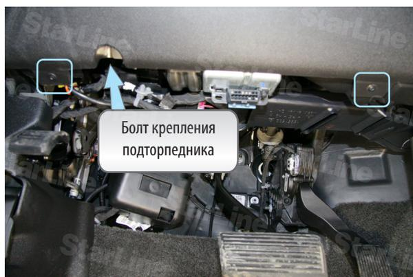
Фото 1.3. Саморезы и болт крепления подторпедника
