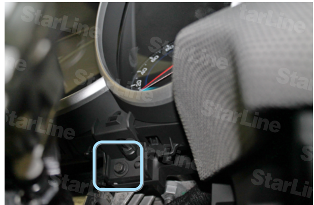
Фото 2.6. Саморез крепления щитка приборов
